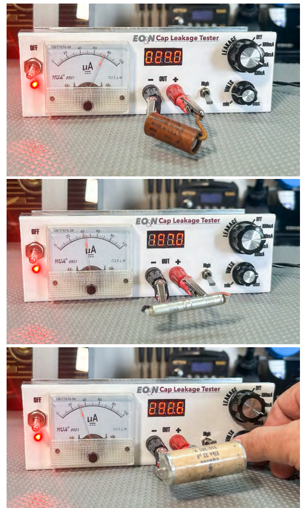
Bild 2: Leckströme können bei erhöhter Spannung unterhalb der maximalen Nennspannung des Bauteils gemessen werden.
