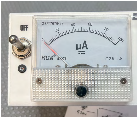
Bild 9: Das 100- \mu A-Analogmessgerät mit 0,216-V-Abfall bei Vollausschlag
