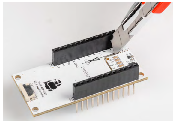
Bild 7: Wenn gewünscht, kann die Ausbrechplatte mit einem Cuttermesser oder Seitenschneider herausgetrennt werden.
