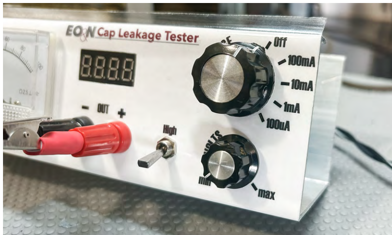
Bild 13: Die sorgfältige Verwendung des Bereichsschalters und der Spannungseinstellung ist für den sicheren Betrieb des Testers von entscheidender Bedeutung.
