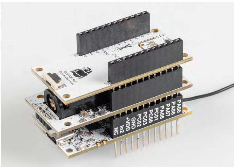
Bild 8: Ein Modulstapel mit der ELV Smart Home Sensor-Base (unten), einem ELV Powermodul LR03 (Mitte) und einem ELV Applikationsmodul Hallsensor
