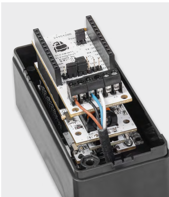
Bild 10: Am Interface angeschlossenes Sensorkabel des SoMo1
