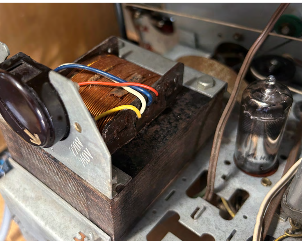
Bild 1: Netztransformator auf dem Chassis eines Graetz Melodia
