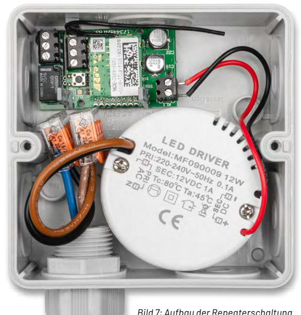
Bild 7: Aufbau der Repeaterschaltung
