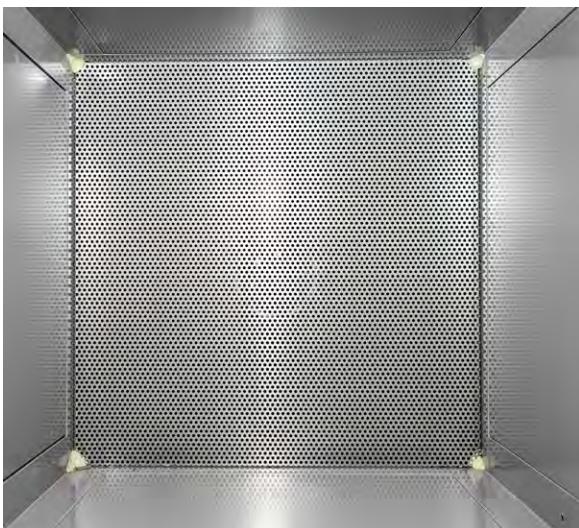
Bild 5: Engmaschiges Lochblech im Rauchkanal zur weiteren homogenen Aerosolverteilung
