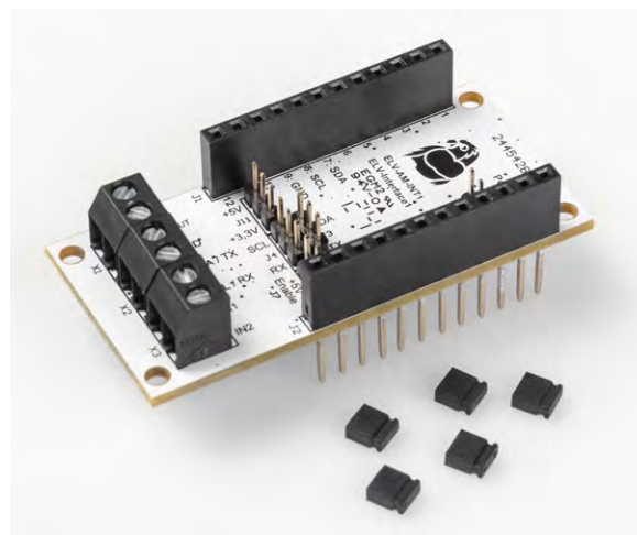
Bild 2: Lieferungsumfang des Interface ELV-AM-INT1
