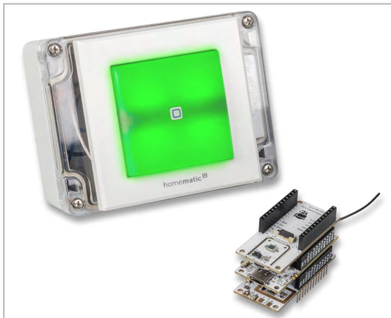
Bild 12: Eine UV-Ampel in der Kombination aus Homematic IP Schaltaktor für Markenschalter mit Signalleuchte HmlP-BSL, ELV Applikationsmodul Optische Strahlungssensoren ELV-AM-ORS, ELV Powermodul Buttoncell LR44 ELV-PM-BC und ELV Smart Home Sensor-Base ELV-SH-BM-S
