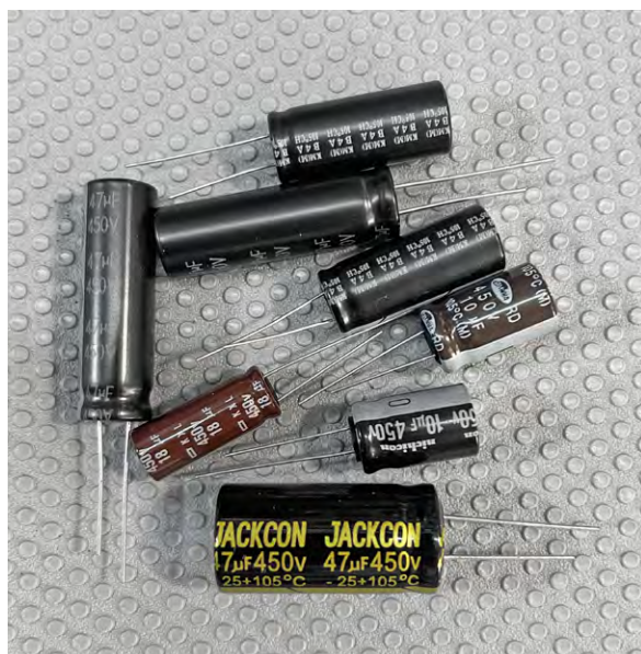
Bild 8: Verschiedene Typen von Elektrolytkondensatoren für hohe Spannungen
