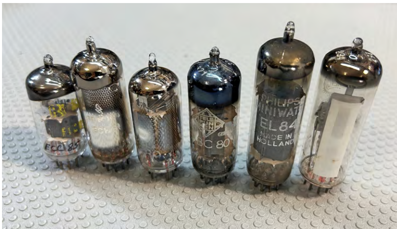
Bild 6: Der vollständige Satz der im Grundig 2147 verwendeten Röhren
