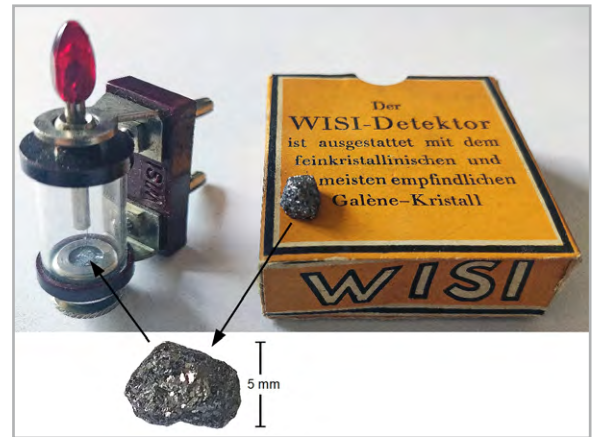
Bild 2: Ein Kristalldetektor der Firma WISI, der bis Anfang der 1960er-Jahre gebaut wurde.
