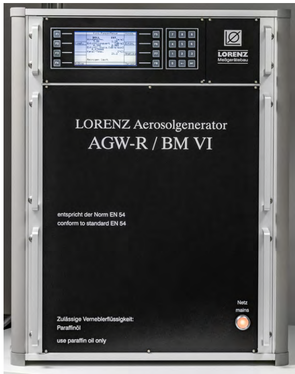
Bild 6: Aerosolgenerator des EN-54-Prüfkanals
