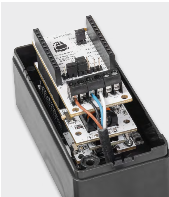
Bild 10: Am Interface angeschlossenes Sensorkabel des SoMo1
