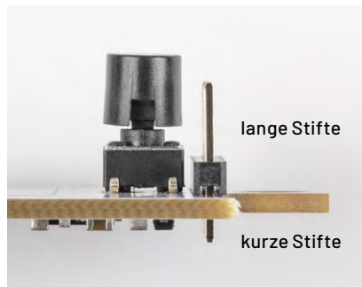
Bild 21: So wird die Stiftleiste J4 eingesetzt.
