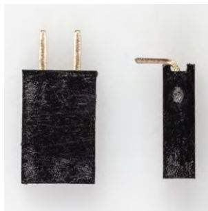
Bild 19: So wird die Buchse J3 vorbereitet.
