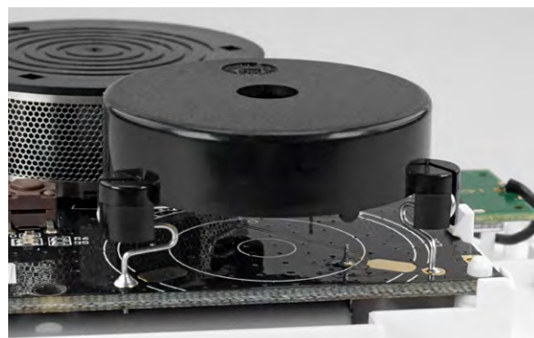
Bild 7: Der Piezo-Buzzer ist über federnde Anschlüsse auf die Leiterplatte gelötet.
