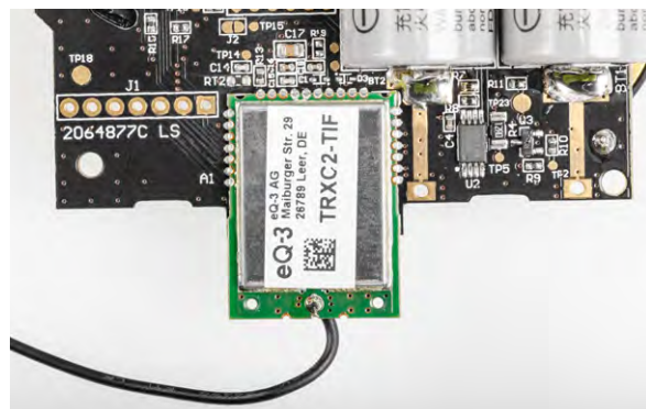
Bild 6: Das abgeschirmte Transceiver-Funkmodul ist direkt auf die Leiterplatte des Rauchwarnmelders gelötet.
