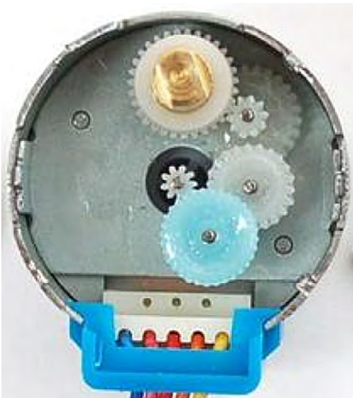
Bild 2: Die Rotordrehung des Steppermotors wird durch ein mechanisches Getriebe auf 1/64 reduziert (meistens).
