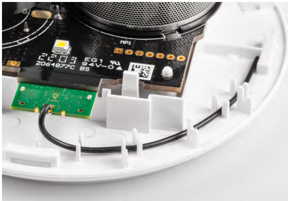
Bild 9: Eine genau definierte Verlegung der Antenne des Transceivermoduls sorgt für eine reproduzierbare Abstrahlcharakteristik.
