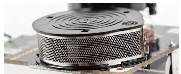
Bild 3: Feinmaschiges, im Ätzverfahren hergestelltes Edelstahl-Insektenschutzgitter um die Rauchkammer herum
