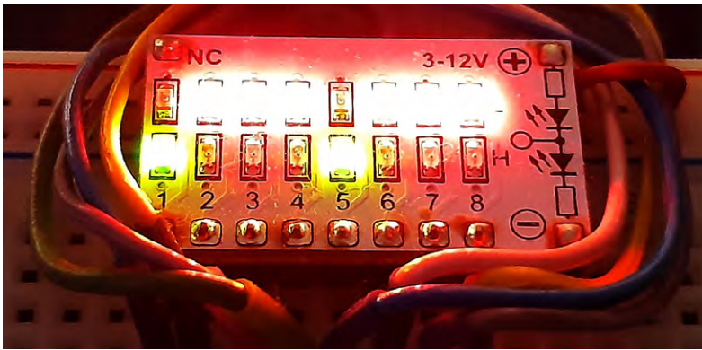
Bild 9: Der Binärzähler zeigt die Zahl 17(10001000).
