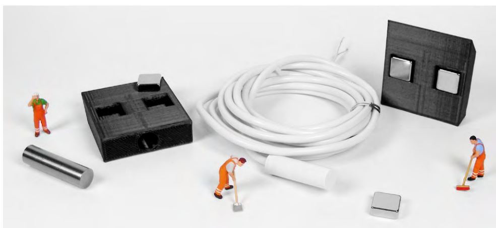
Bild 4: Reedkontakt, Auslösemagnet und Halterungen
