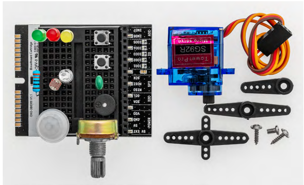
Bild 3: Breadboard-Cartridge mit Bauteilen
