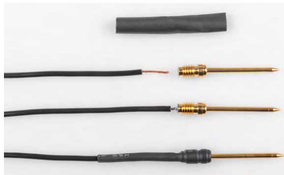
Bild 26: So wird das Prüfkabel angefertigt.
