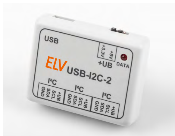
Bild 5: Abgeschlossene Gehäusemontage mit kurzem Jumper
