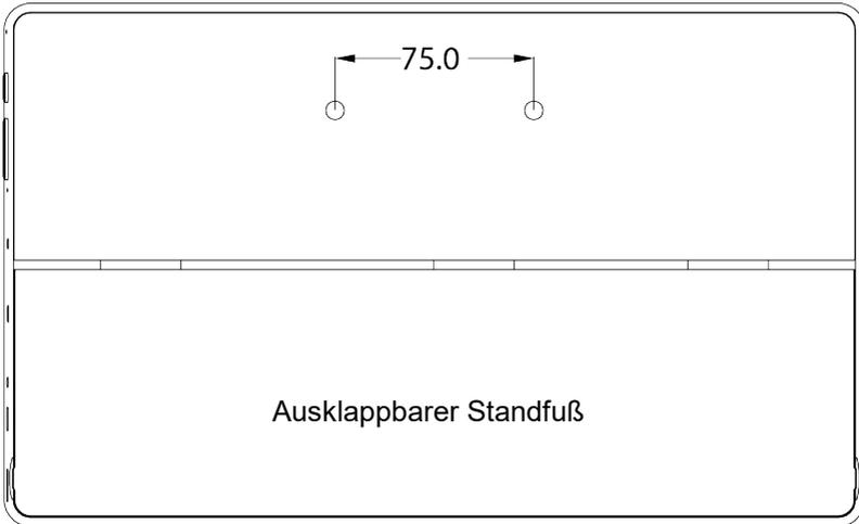
Das Gerät besitzt auf der Rückseite zwei Gewinde im Abstand von 75 mm zueinander zum horizontalen Aufhängen an der Wand oder zur Montage an handelsüblichen Monitor/TV Halterungssystemen. Wenn Sie das Gerät frei aufstellen möchten, benutzen Sie den ausklappbaren Standfuß.
