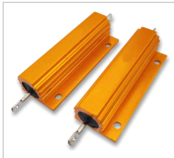
Bild 4: Diese 8-Ω-/100-W-Widerstände sind ideal, da sie gute Wärmeableitungseigenschaften bieten.
