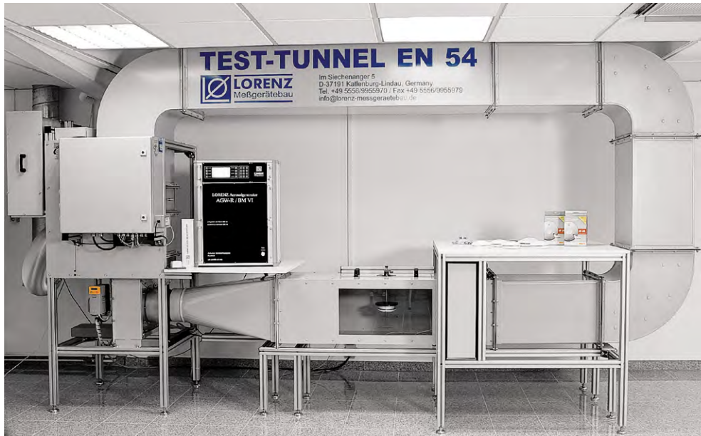
Bild 2: Rauchwarnmelder-Prüfkanal nach EN 54
