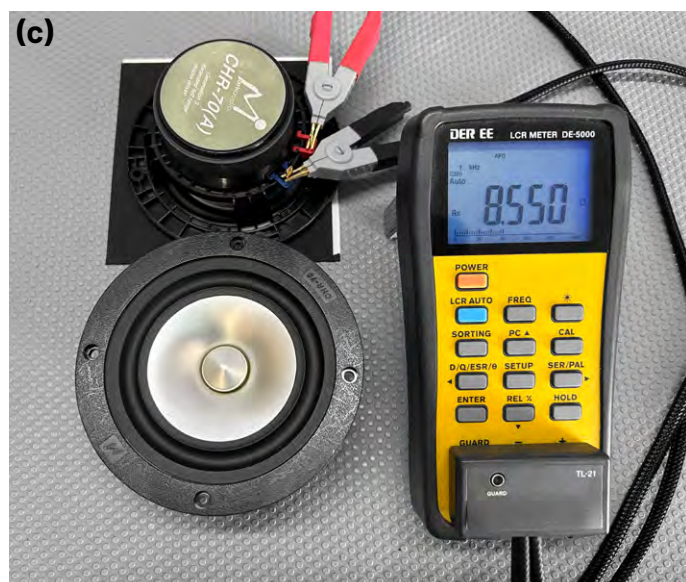
Bild 3: Impedanz gemessen bei verschiedenen Frequenzen: (a) DC; (b) 100 Hz; (c) 1 kHz; (d) 10 kHz
