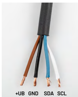
Bild 5: Die Funktionsbelegung der farbigen Sensoranschlüsse
