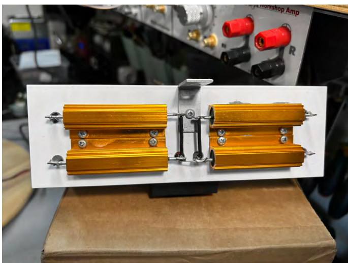
Bild 9: Die interne Verkabelung erfolgt vollständig Punkt zu Punkt, mit guter Qualität. Die Widerstände befinden sich auf der Rückseite, was die Wärmeableitung verbessert.
