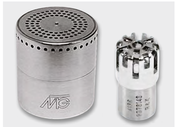
Bild 2 links: 1-Zoll-Messmikrofon-Kapsel Typ MK 112 von Microtech Gefell GmbH, Messfrequenzbereich: 10 Hz–20 kHz, Leerlauf-Übertragungsfaktor: T_E = 50 \text{ mV/Pa} , Übertragungsmaß: G_E = -26 \text{ dB} (re 1 \text{ V/Pa} ), Kapseldurchmesser: 23,77 mm Bild 2 rechts: 1/8-Zoll-Messmikrofon-Kapsel, Typ 4138 von Brüel & Kjær, Messfrequenzbereich: 6,5 Hz–40 kHz, Leerlauf-Übertragungsfaktor: T_E = 1 \text{ mV/Pa} , Kapseldurchmesser: 3,5 mm, Grenzschalldruckpegel: 168 dB
