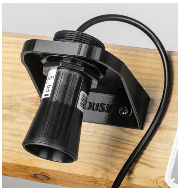
Bild 7: Montage des Sensors mit einem Haltewinkel
