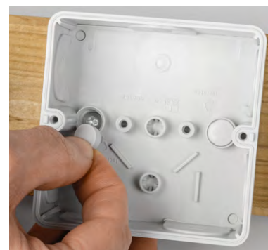
Bild 9: Einsetzen der Abdichtungen vor dem Einsetzen der Platine
