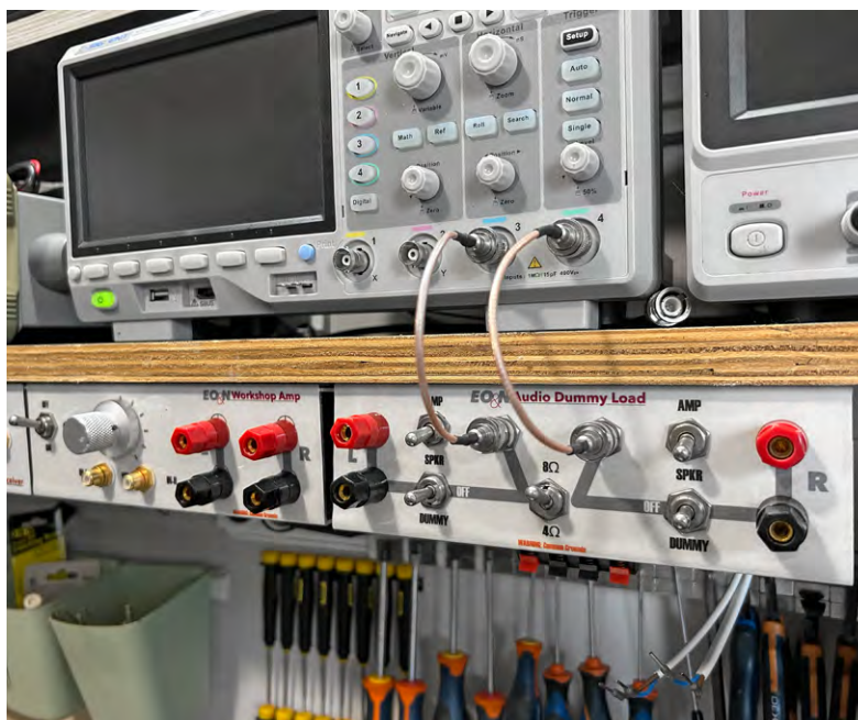
Bild 8: Das Unterregalsystem macht die Verbindungen zum Anschluss eines Oszilloskops einfach und übersichtlich.
