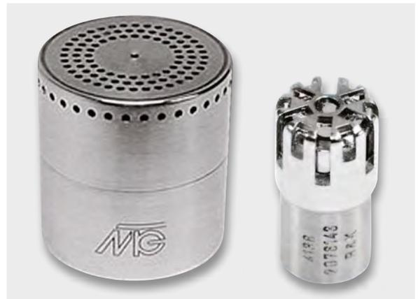
Bild 2 links: 1-Zoll-Messmikrofon-Kapsel Typ MK 112 von Microtech Gefell GmbH, Messfrequenzbereich: 10 Hz–20 kHz, Leerlauf-Übertragungsfaktor:  $T_E = 50 \text{ mV/Pa}$ , Übertragungsmaß:  $G_E = -26 \text{ dB}$  (re 1V/Pa), Kapseldurchmesser: 23,77 mm
