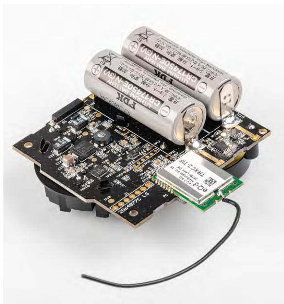
Bild 5: Fest eingebaute Lithium-Batterien im ELV/e0-3-Rauchwarnmelder HmlP-SWSD
