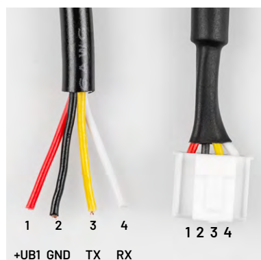
Bild 5: Die korrekte Zuordnung der Kabelfarben des Sensors zu den Klemmen des Interface 1
