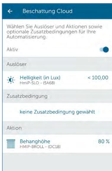
Bild 3: Automatisierung in der Cloudlösung
