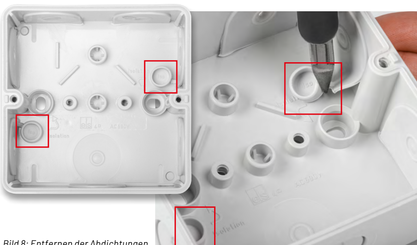
Bild 8: Entfernen der Abdichtungen
