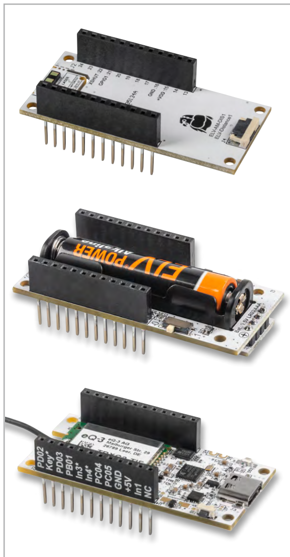
Bild 2: Die Module ELV-SH-BM-S (unten) und ELV-AM-DIS1 (oben) können übereinandergesteckt und durch das ELV-PM-LR03 (Mitte) mit einer Microzelle (AAA) betrieben werden.
