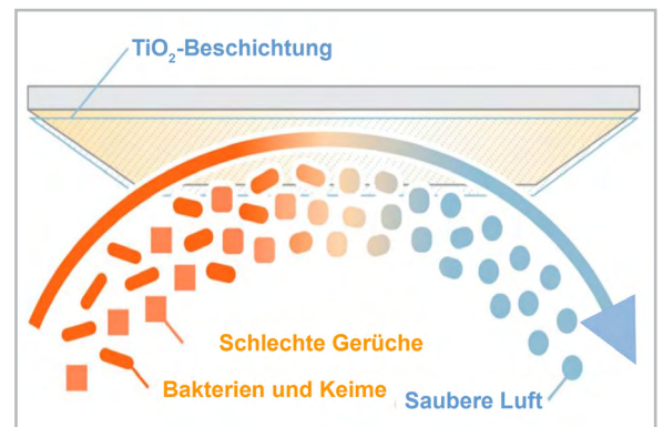
Bild 5: Wenn organische Schadstoffe in der Luft (Bakterien, Keime, Gerüche und flüchtige Verbindungen) mit Licht bestrahlte TiO 2 -beschichtete Oberflächen passieren, werden die Schadstoffe dezimiert. Ein wichtiger Beitrag zur Hygiene. Bild: LEDVANCE GmbH
