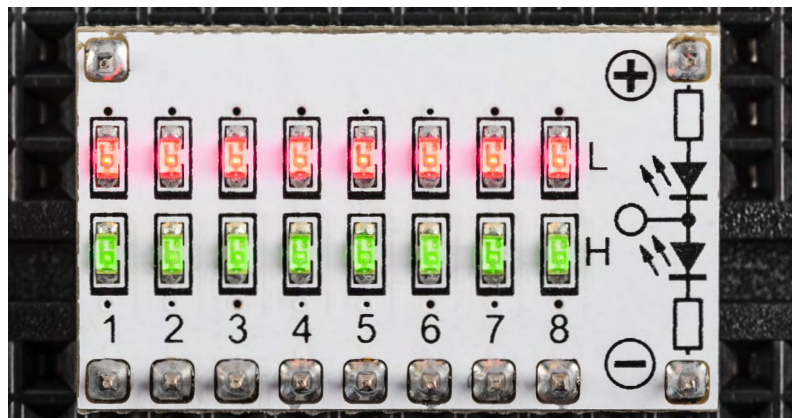
Bild 9: undefinierter Pegel am Logic-Level-Modul
