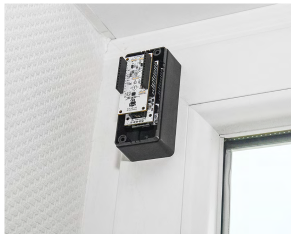
Bild 11: Das ELV Applikationsmodul Lagesensor lässt sich am besten in Verbindung mit dem modularen Gehäuse MHO101a anbringen.
