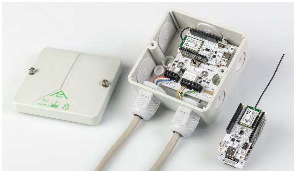
Jetzt kann das erste Basismodul programmiert werden. Nach der erfolgreichen Programmierung muss dieser Schritt für die zweite ELV-LW-Base wiederholt werden. Alternativ kann statt einer ELV-LW-Base auch ein ELV-LW-MOB verwendet werden. Dieser Fall wird weiter unten beschrieben.
