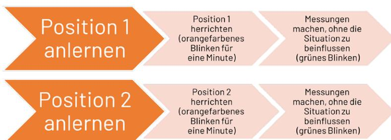
Bild 10: Anlernprozess Magnetfeldsensor
