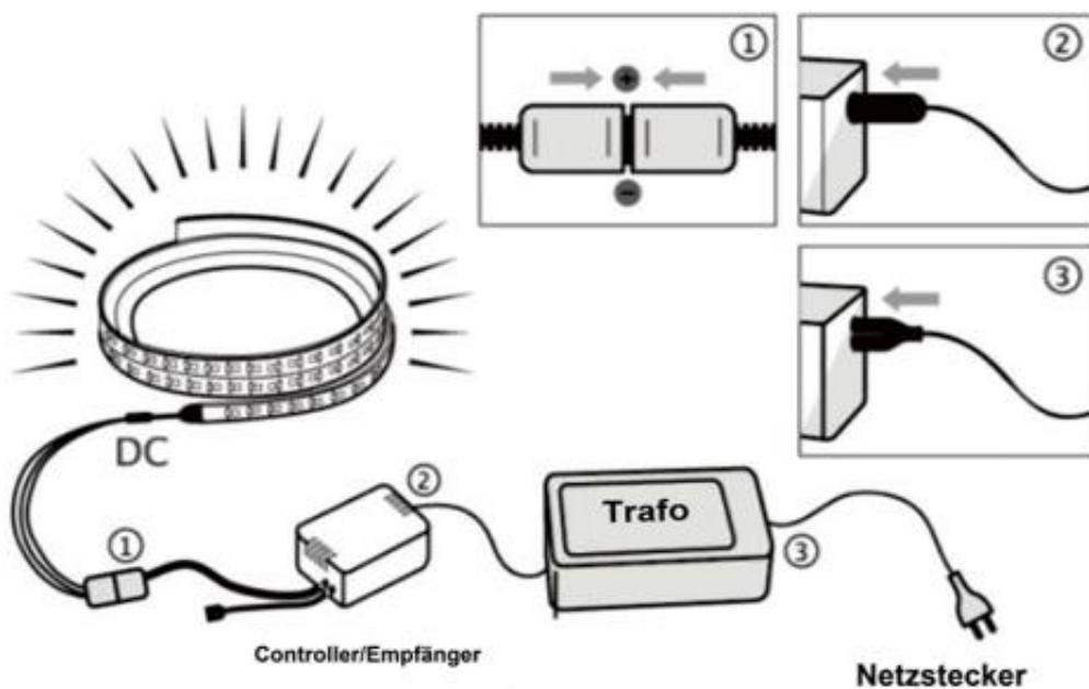
Verbinden Sie den LED Streifen mit dem Controller (Output) und schließen Sie die Sekundärseite des Netzteiltes 8Gleichspannung/Output) an den Controller (Input) an. Schließen Sie zuletzt das Netzteil an, um den Streifen in Betrieb zu nehmen.
