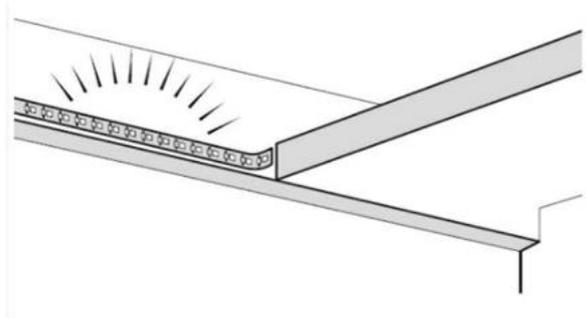
Entfernen Sie Rückseite des Klebestreifen an die dafür vorgesehene Stelle (vorzugsweise in ein Aluminium-Profil)
