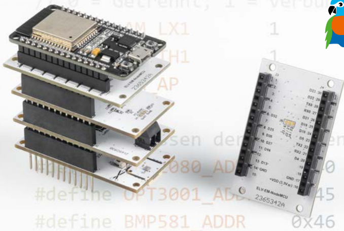
ELV Erweiterungsmodul NodeMCU
