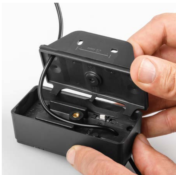
Bild 15: Einführen des Kabels in das ELV-Modulgehäuse
