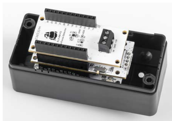
Bild 9: Stapel aus ELV-LW-Base, ELV-PM-LR03 und dem Applikationsmodul ELV-AM-FD
