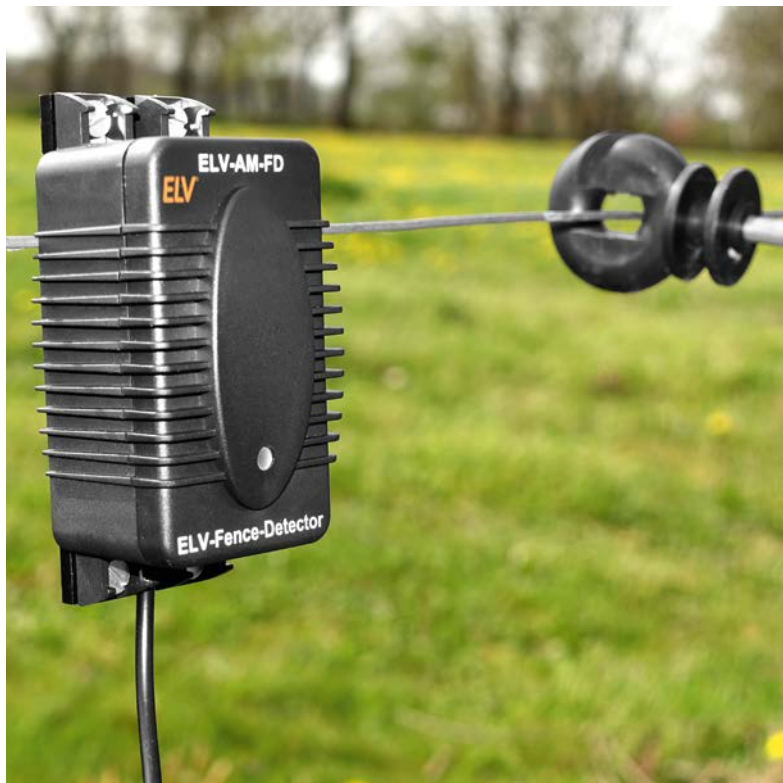
Bild 21: Nach Einstellen der Ansprechempfindlichkeit wird der Sensor verschlossen und fest montiert.
