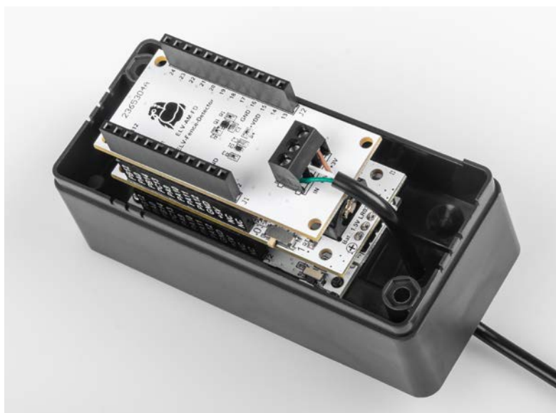
Bild 16: Anschluss des Kabels an das Applikationsmodul
