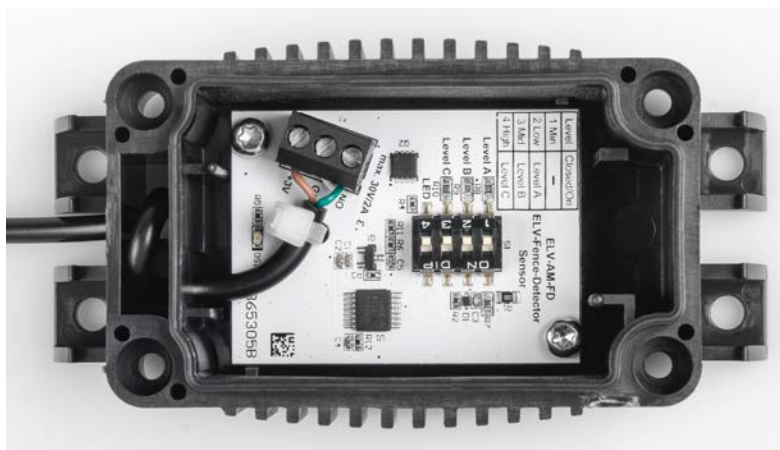
Bild 14: Befestigung der Platine mit den kürzeren Innensechskant-Schrauben
