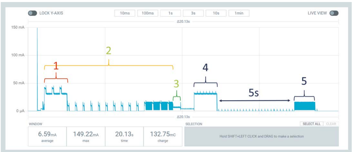
Bild 11: Stromaufnahme des Beleuchtungsstärkeensors nach Einschalten der Versorgungsspannung
