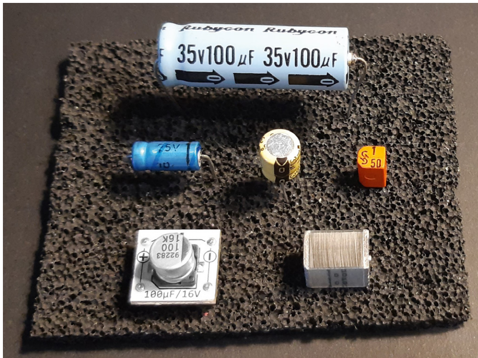
Bild 8: Elkos in verschiedenen Ausführungen
