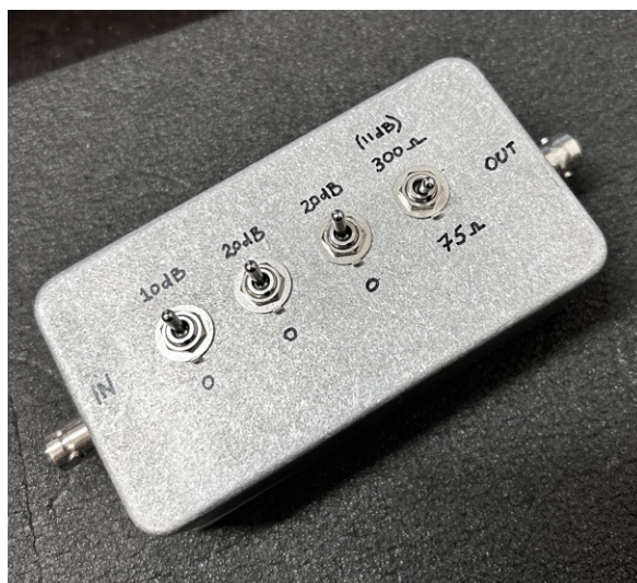
Bild 12: Ein Stufen-Dämpfungsglied mit L-Pad zur Verwendung bei UKW-HF-Abgleichen
