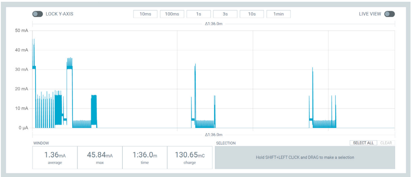
Bild 10: Ausschnitt aus der Strommessung der ELV-LW-Base mit Applikationsmodul Luxmeter
