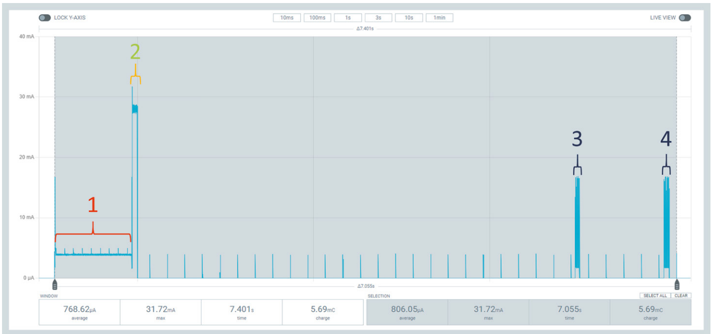
Bild 15: Zyklische Messung, Übertragung der aktuellen Beleuchtungsstärke und LoRaWAN®-RX-Fenster
