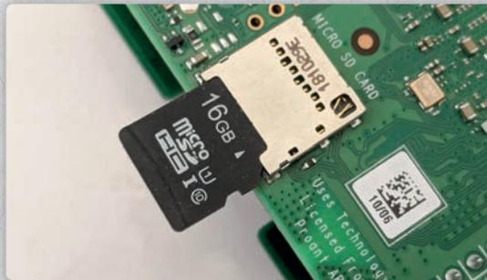
**Abb. E.3:** MicroSD-Karte 16 GB Class 10 im Raspberry Pi 4. Die Zahl im Kreis gibt die Klassifizierung der Speicherkarte an.
