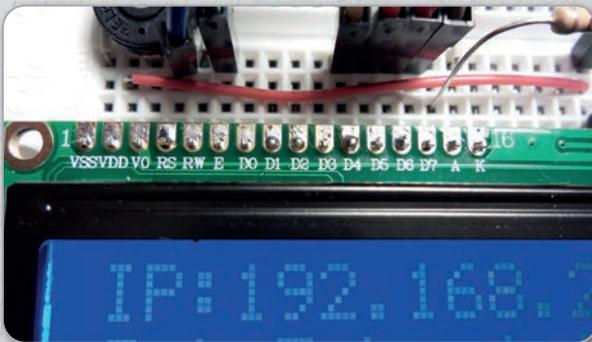
**Abb. 9.1:** Die 16 Anschlusspins des LC-Displays.
