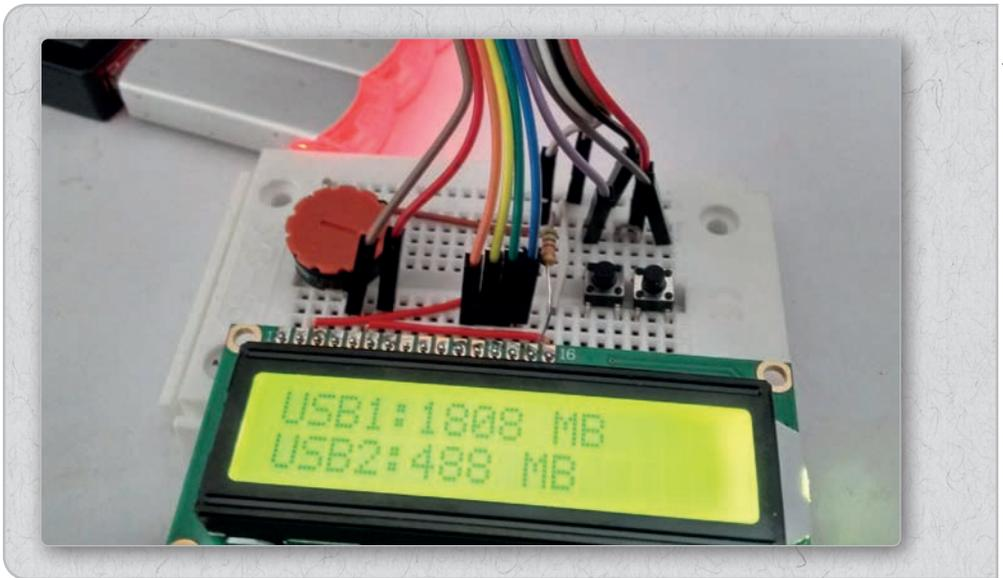
**Abb. 15.3:** LC-Display mit zwei Tastern auf einer Steckplatine.
