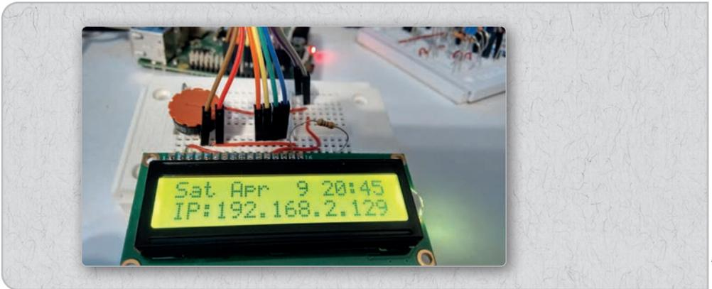
**Abb. 1.3:** Zweizeiliges LC-Display auf einer Steckplatine am Raspberry Pi.
