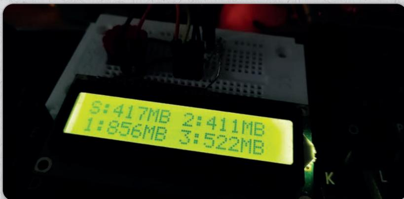
**Abb. 14.1:** Statusanzeige für drei USB-Sticks, am Raspberry Pi angeschlossen.
