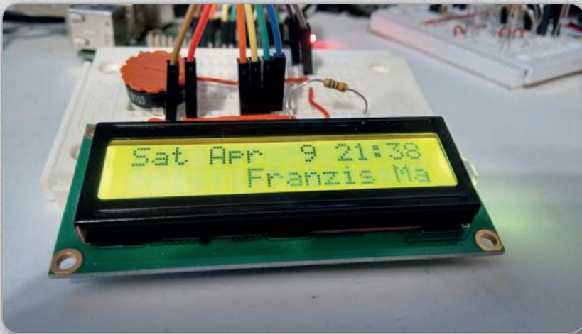
**Abb. 12.1:** Uhr und Laufschrift auf dem LC-Display.
