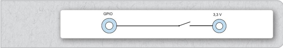
**Abb. 4.2:** Ein Taster verbindet einen GPIO-Eingang mit +3,3 V.
