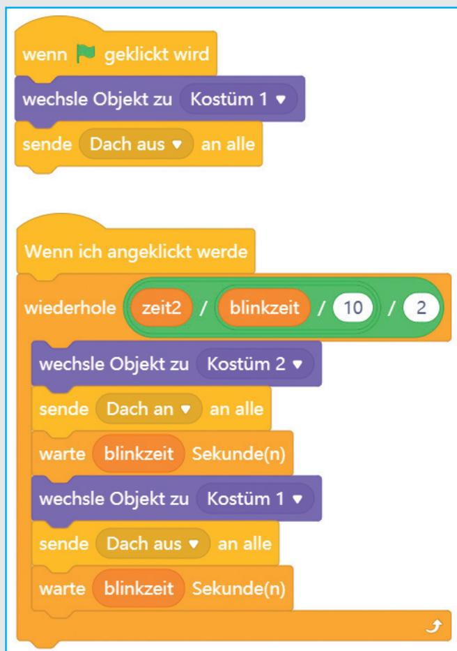
Um die Anzahl der Wiederholungen zu berechnen, wird zunächst die Gesamtzeit durch die Blinkzeit geteilt. Die Blinkzeit, die in Zehntelsekunden eingestellt wird, wird dabei vorher durch 10 geteilt. Das Ergebnis wird noch einmal durch 2 geteilt, da jeder Schleifendurchlauf zwei Blinkzeiten dauert. Während der ersten Blinkzeit ist die LED an Pin D9 eingeschaltet, während der zweiten ist sie aus.
