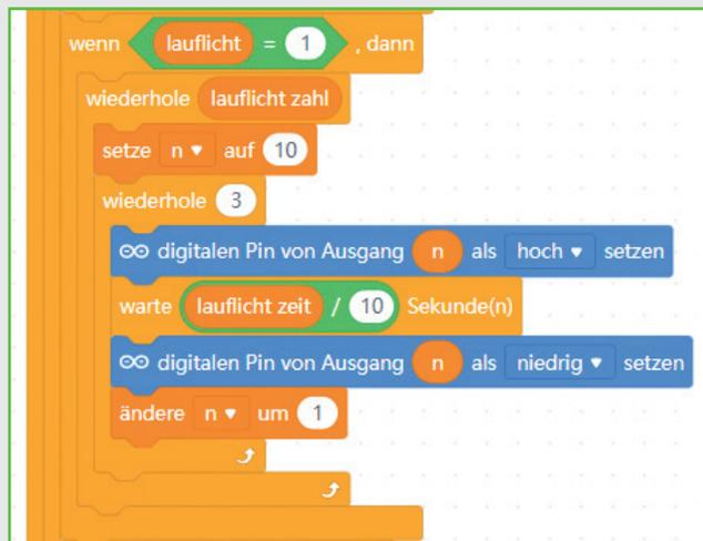
Die Figur *Laufflicht* schaltet das Lauflicht aus drei LEDs an den Pins D10 bis D12 ein oder aus. Die Umschaltung funktioniert analog zu den anderen Figuren. Im Lauflicht wird nacheinander je eine LED ein- und nach einer kurzen Wartezeit, die mit dem Schieberegler *laufflicht zeit* eingestellt wird, wieder ausgeschaltet.
