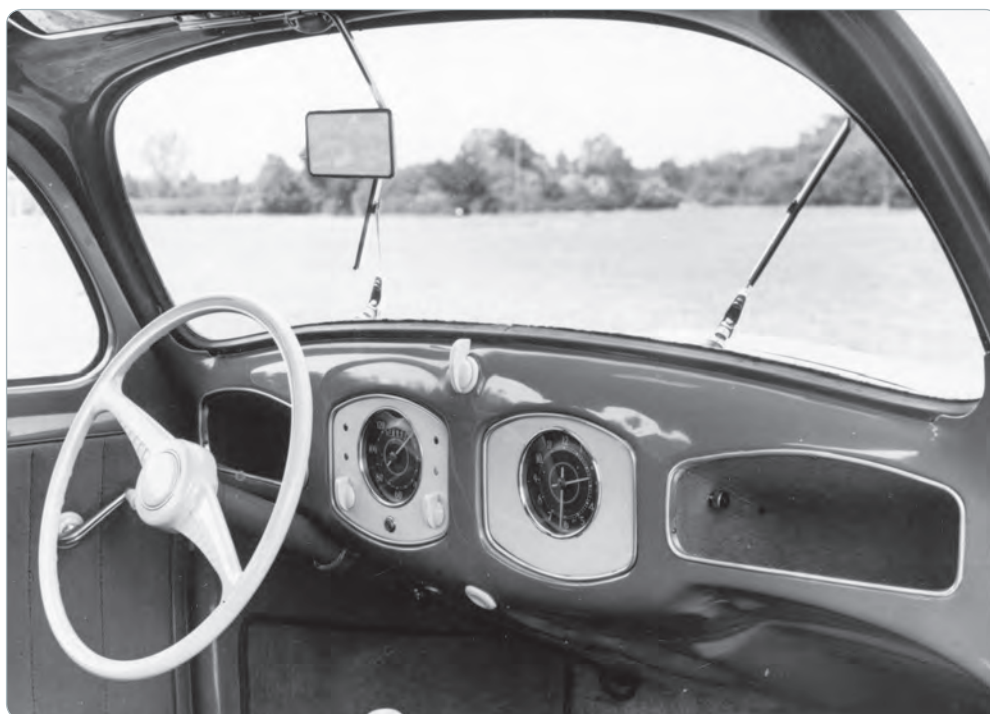
Das Armaturenbrett des Export-Modells. Kennzeichen sind Handschuhkästen und Instrumententräger mit Chromleisten. Dazu gibt es ein Zweispeichen-Lenkrad. Die Bedienknöpfe sind aus elfenbeinfarbigem Kunststoff.
