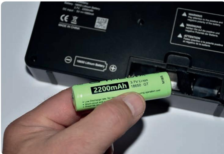
*Lithium-Ionen-Akkus der Industrienorm 18650 finden nicht nur in diversen Elektrogeräten, sondern auch in E-Autos Anwendung. Lithium-ion batteries of the industrial standard 18650 are not only used in various electrical appliances, but also in e-cars.*
