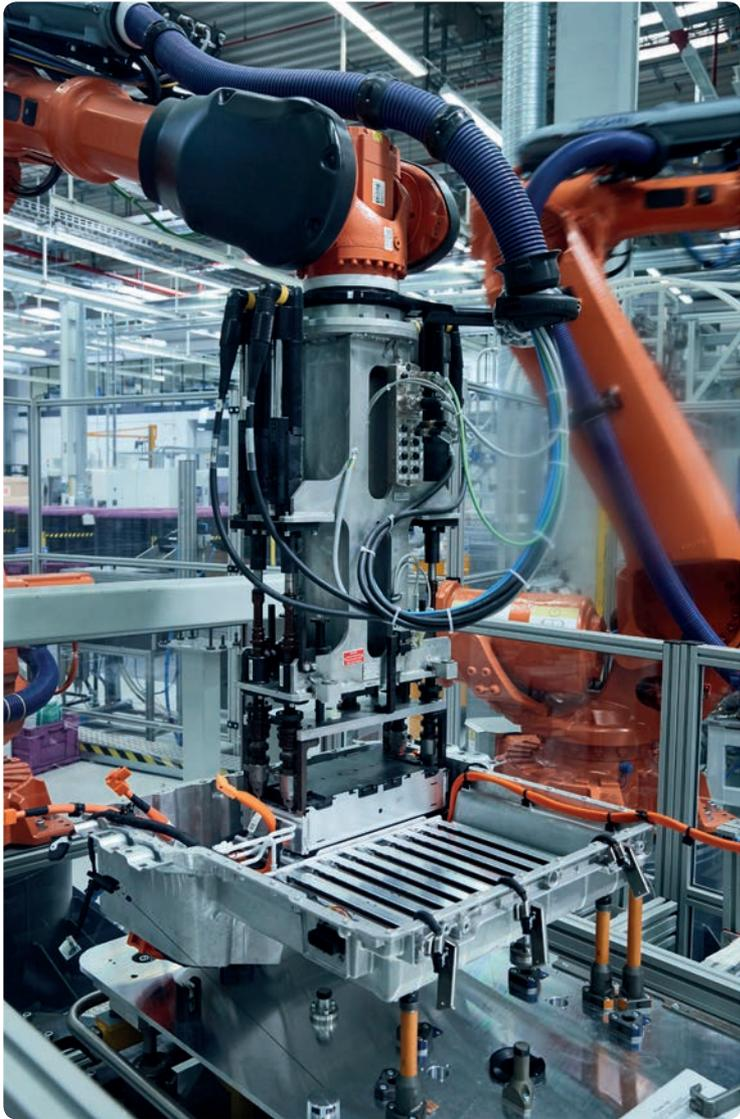
*Die einzelnen Akkublöcke werden maschinell in das stabile Metallgehäuse eingesetzt.*
