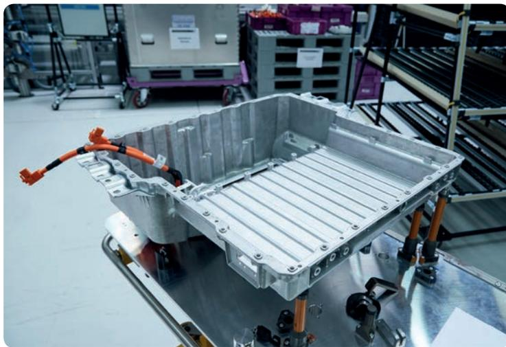
*Fahrakkus werden in ein stabiles Gehäuse eingebaut. Es schützt die empfindlichen Akkus vor Erschütterungen, Verunreinigungen und mechanischen Beschädigungen.*
