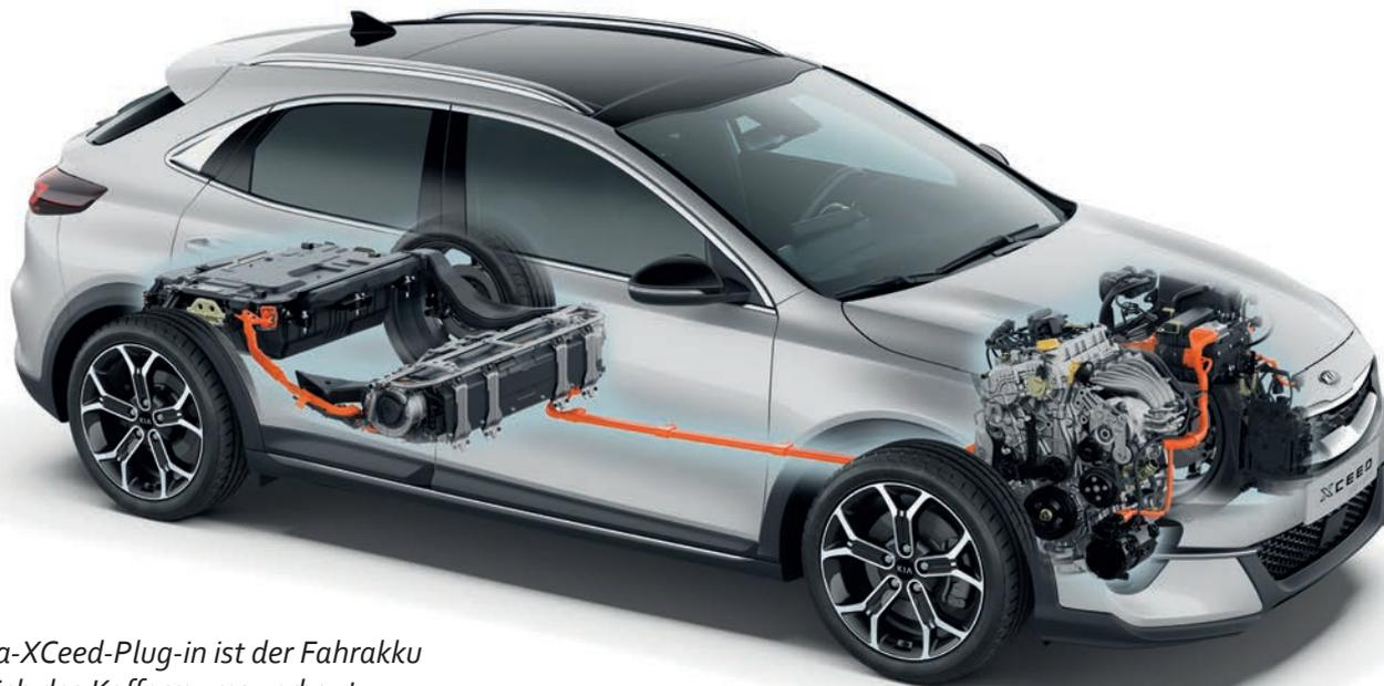
Beim Kia XCeed-Plug-in ist der Fahrakku im Bereich des Kofferraums verbaut.
