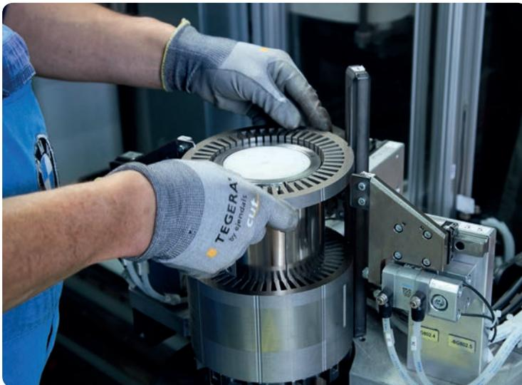
*Der Stator ist aus zahlreichen dünnen Blechen zusammengesetzt. So werden Wirbelstromverluste vermieden.
