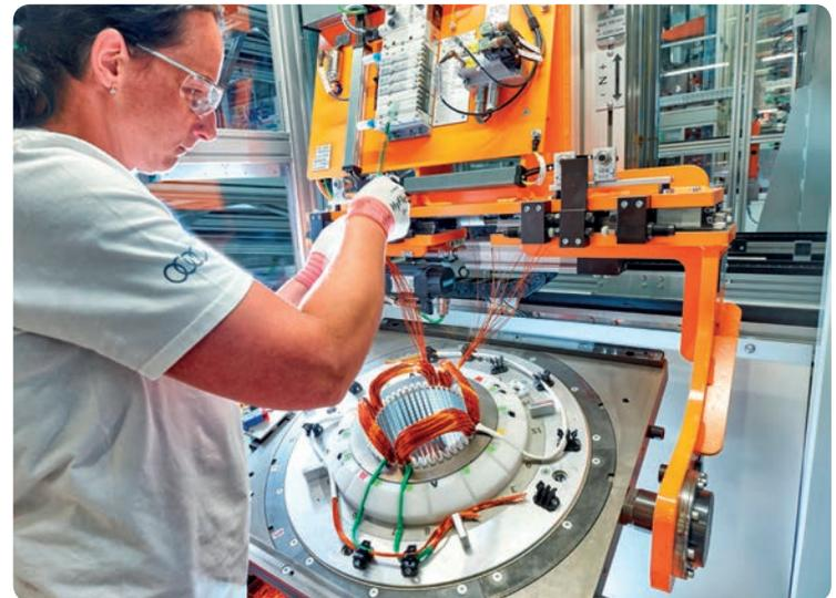
*In die Statorbleche werden die Windungen des E-Motors eingesetzt.
