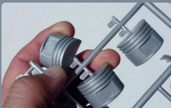
*Sie können die Teile behutsam mit der Hand oder mit einer kleinen Zange lösen. In beiden Fällen wird an der Bruch- oder Schnittstelle ein Grat übrig bleiben. Schneiden Sie ihn vorsichtig mit einem Tapetenmesser ab, sodass durchweg plane Oberflächen entstehen. Eventuell eignet sich dazu auch eine feine Feile.*
