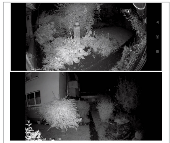
Bild 10: In völliger Dunkelheit bewirkt die unsichtbare Infrarotausleuchtung scharfe Schwarz-Weiß-Aufnahmen.
