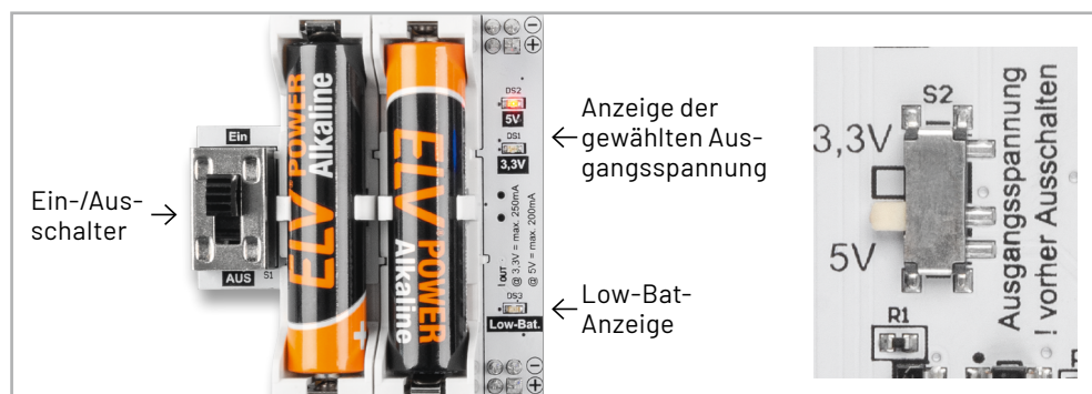
Bild 1: Die Bedien- und Anzeigenelemente des Powermoduls PM-SB1
