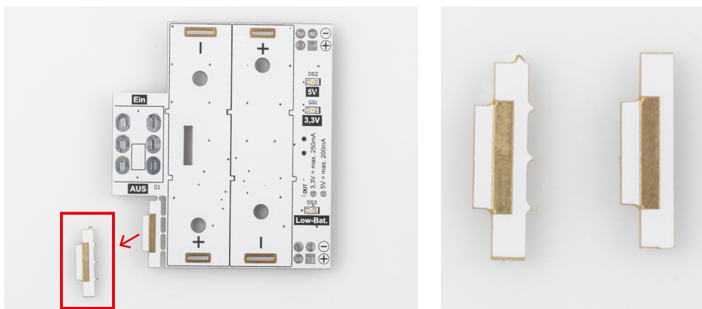
Bild 9: Die Abstandshalterplatine ist mit kleinen Stegen an der Basisplatte befestigt.
