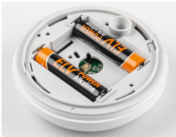
Bild 17: Einlegen der Batterien
