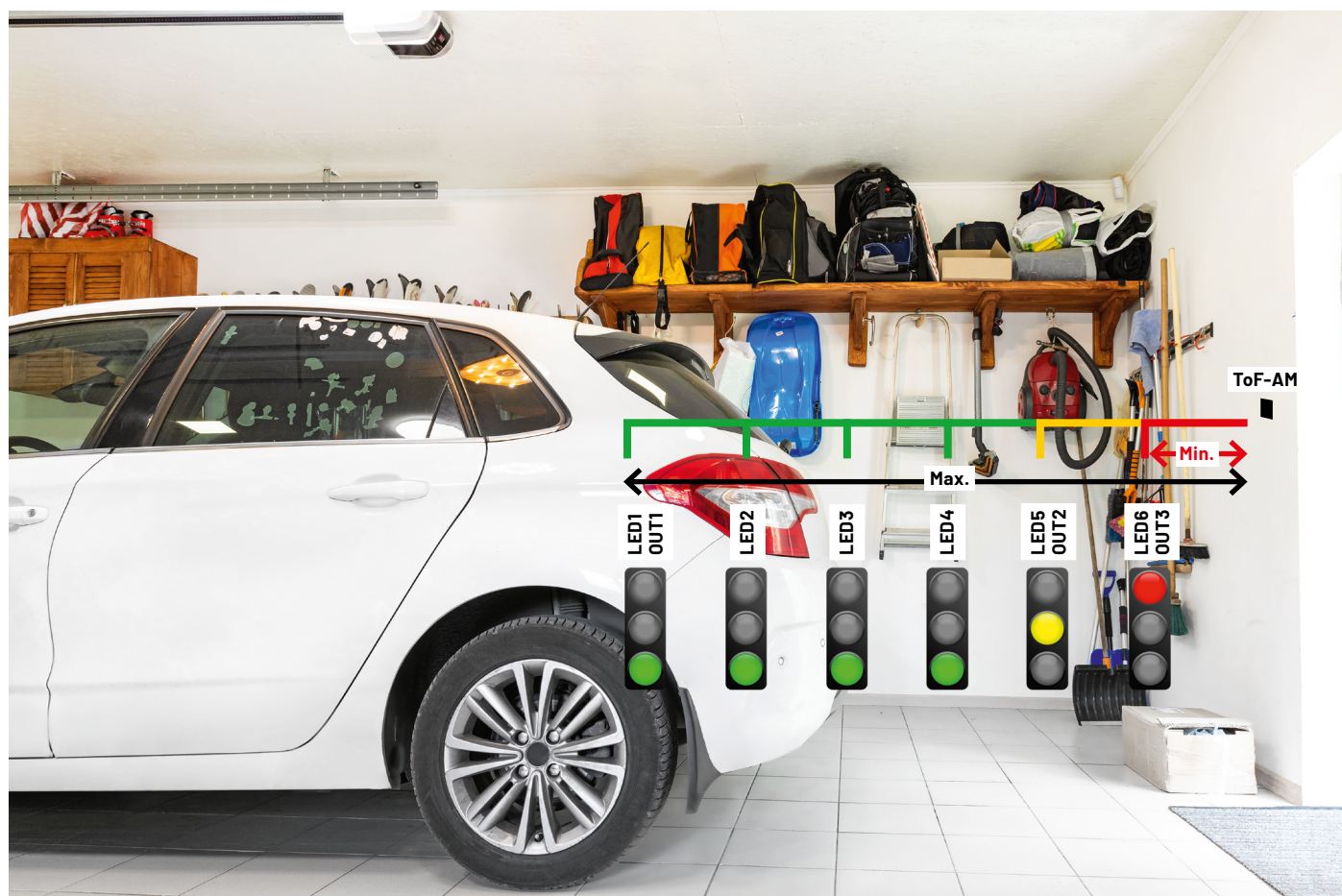
Anwendungsbeispiel als Abstandsmelder mit dem Verhalten der LEDs und der Relaisausgänge
