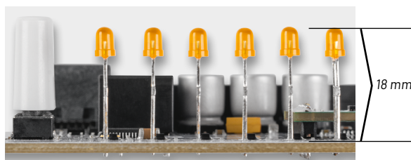
Bild 10: Einbauhöhe der LEDs
