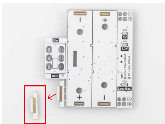
Bild 9: Die Abstandshalterplatine ist mit kleinen Stegen an der Basisplatine befestigt.
