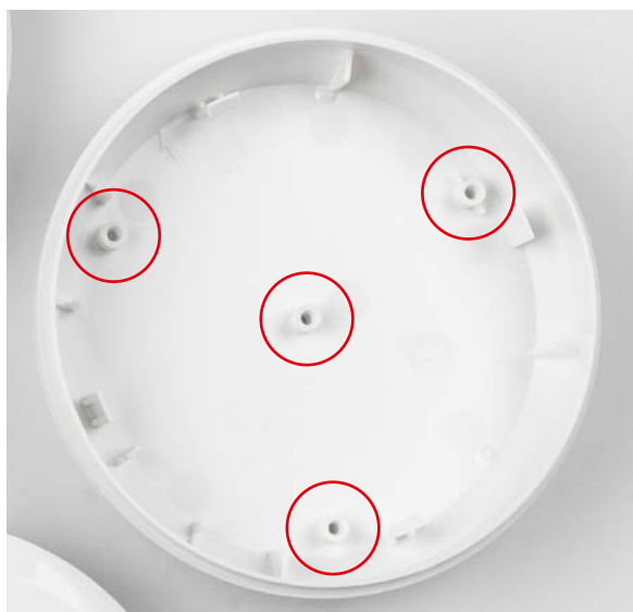
Bild 13: Die Löcher für die Messstifte der Leiterplatte in der Gehäuse- unterschale
