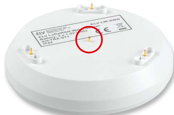
Bild 2: Der Messstift für den Wasserstand ist 1,5 mm höher angeordnet als der Messstift für die Feuchtigkeitsdetektion. Die beiden anderen Stifte sind die jeweiligen Bezugspunkte.
