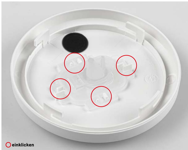
Bild 11: Einsetzen des Lichtleiters (inkl. der zuvor eingesetzten Dichtung) in die Geräteober- schale und Verkleben der Membran
