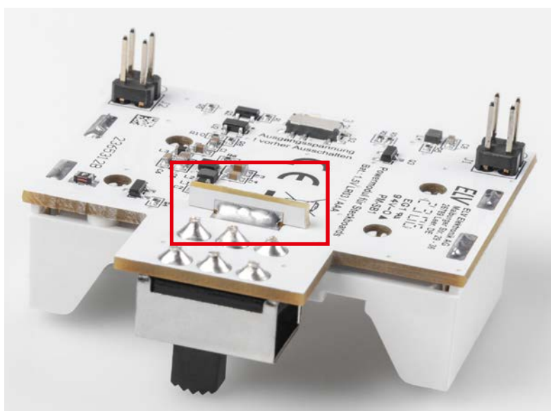
Bild 11: Die Abstandshalterplatine wird mit der Basisplatine verlötet.
