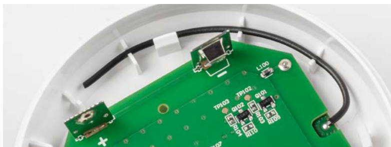
Bild 15: Verlegung der Antenne in der Gehäuseunterschale
