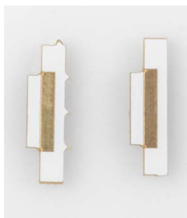
Bild 10: Die Reste der Stege (links) werden mit einer Feile geglättet (rechts).
