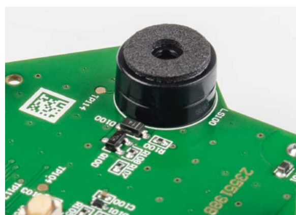
Bild 8: Aufbringen des Moosgummirings auf den Signalgeber
