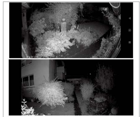
Bild 10: In völliger Dunkelheit bewirkt die unsichtbare Infrarotausleuchtung scharfe Schwarz-Weiß-Aufnahmen.
