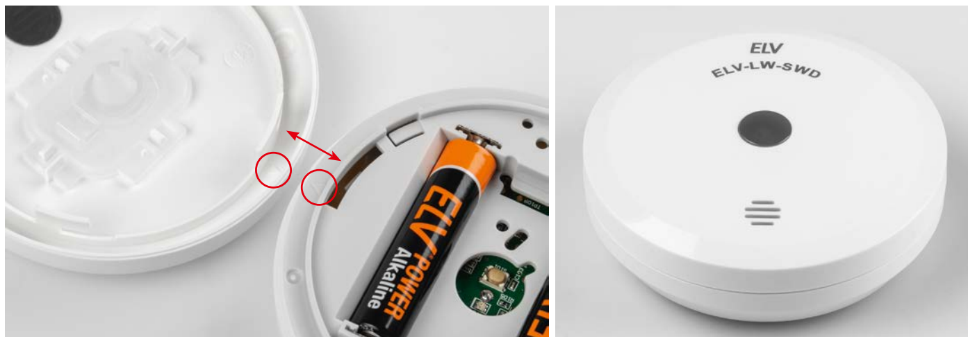
Bild 18: Montage des Gehäusedeckels (links) und das fertig montierte Gerät, nachdem man den aufgesetzten Deckel im Uhrzeigersinn gedreht hat (rechts).
