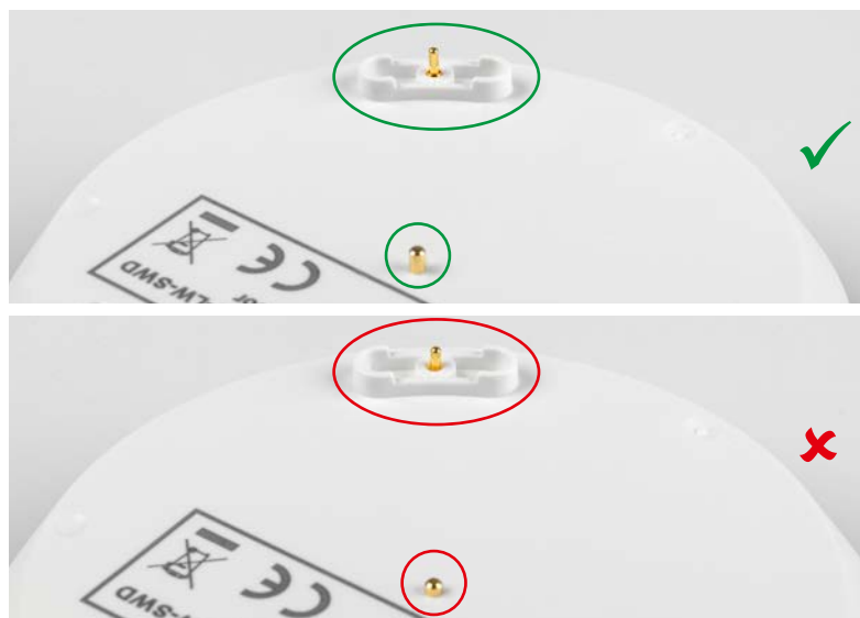
Bild 14: Die Messstifte des Geräts nach dem richtigen (oben) oder unzureichenden Einsetzen (unten) der Leiterplatte
