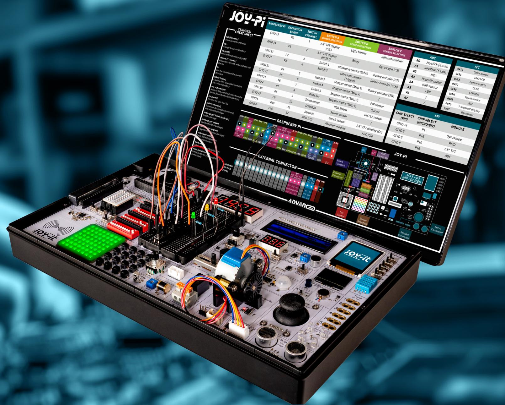
Der Joy-Pi Advanced zeichnet sich insbesondere durch seine intelligenten Schaltereinheiten aus, die eine erweiterte Nutzung der verfügbaren Pins erlauben. Dabei sind insgesamt drei Schaltereinheiten integriert, jede mit 12 einzelnen Schaltern ausgestattet, die für eine präzise Steuerung der verbundenen Sensoren und Module sorgen.
