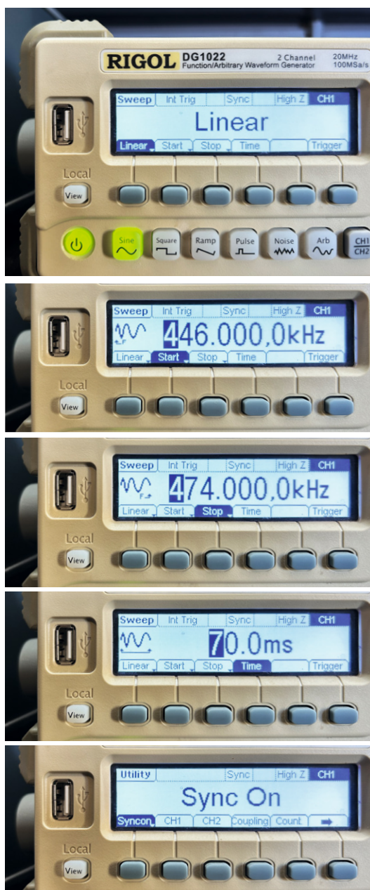
Bild 7: Typische Sweep-Einstellungen für einen visuellen Abgleich einer 460-kHz-Zwischenfrequenz
