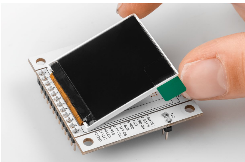
Bild 12: Montage des Displays auf der Platine
