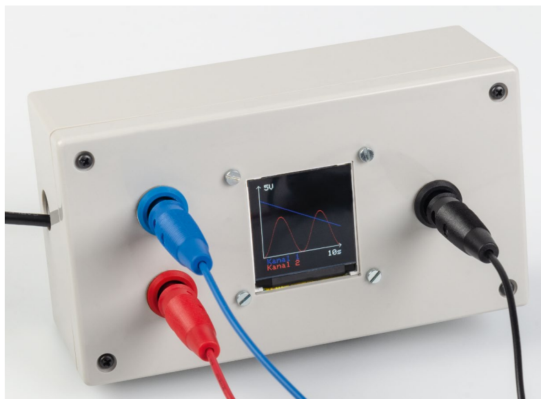
Bild 15: Das PAD-TFT-Display in einem Gehäuse verbaut
