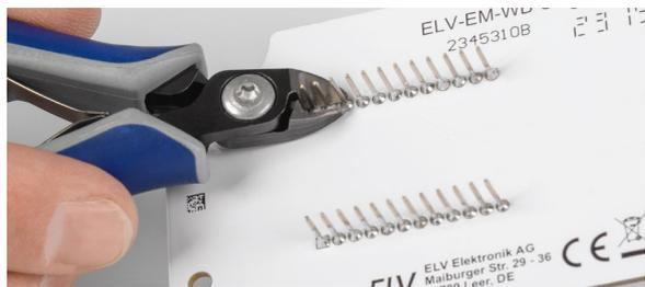
Bild 16: Das Abschneiden der Anschlussdrähte
