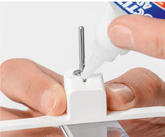
Bild 34: Fixieren der Achse mit Sekundenkleber
