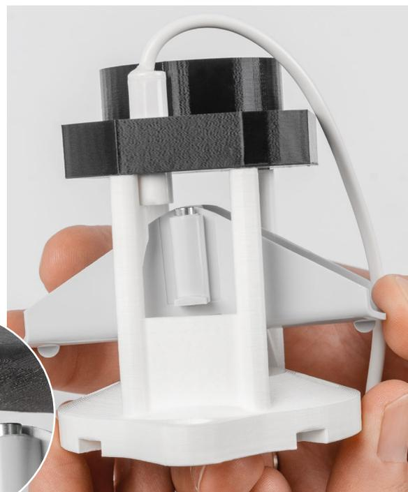
Bild 42: Einsetzen des Reed-Kontakts
