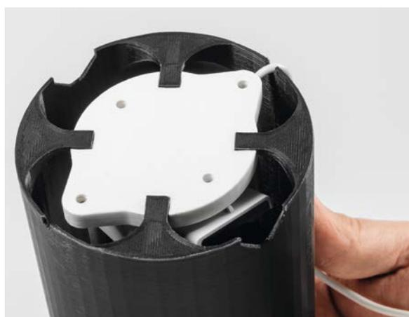
Bild 43: Einsetzen des Wippenhalters in die Abdeckung
