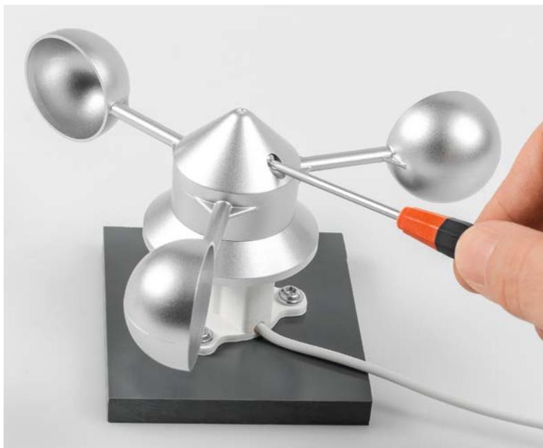
Bild 39: Befestigen der Anemometer-Mechanik auf der Achse
