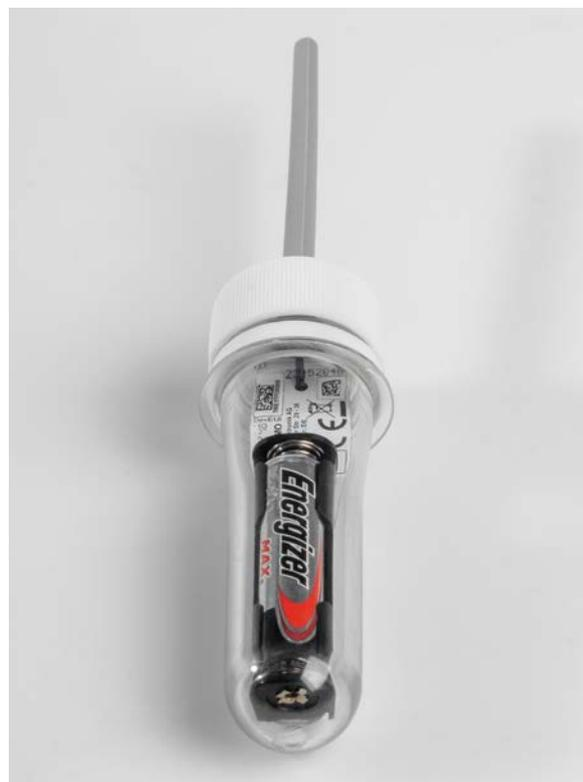
Bild 1: Der Bausatz ELV Erschütterungssensor für LoRaWAN® ELV-LW-OMO
