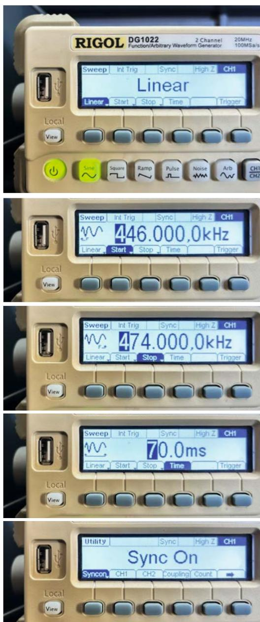
Bild 7: Typische Sweep-Einstellungen für einen visuellen Abgleich einer 460-kHz-Zwischenfrequenz
