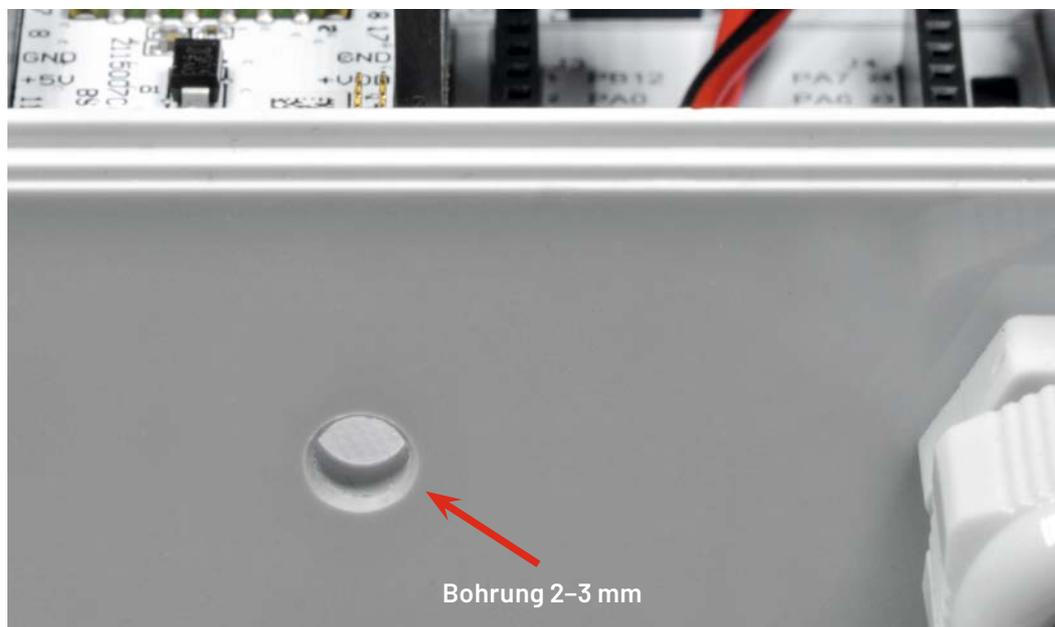
Bild 28: So wird eine Druckausgleichsmembran montiert.
