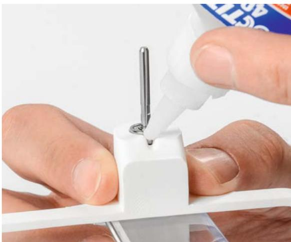
Bild 34: Fixieren der Achse mit Sekundenkleber
