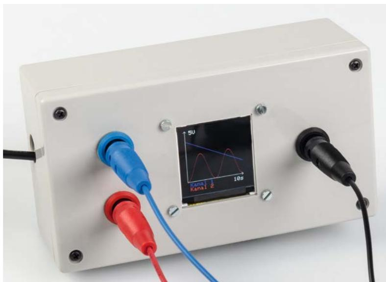
Bild 15: Das PAD-TFT-Display in einem Gehäuse verbaut
