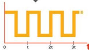
Die meisten Signalgeneratoren, die eine Sweep-Funktion bieten, verfügen auch über einen Sync-Ausgang, der eine Rechteckwelle darstellen kann, mit einer Periode, die der Sweep-Zeit T entspricht und als Triggersignal für das Oszilloskop verwendet werden kann.
