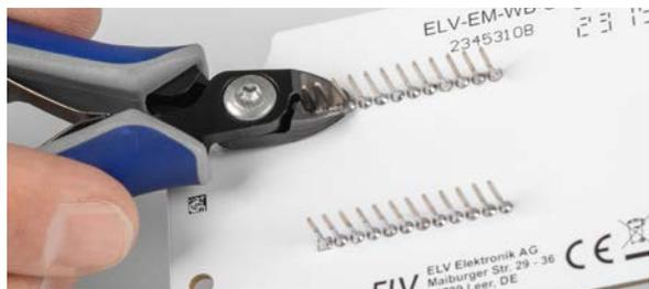
Bild 16: Das Abschneiden der Anschlussdrähte
