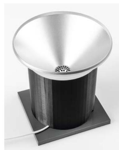
Bild 44: Aufsetzen des Regentrichters auf die Konstruktion
