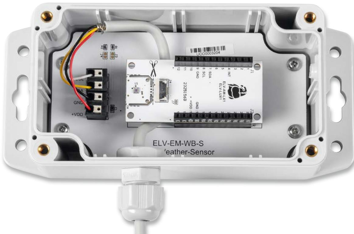
Bild 25: Ein abgesetzter I<sup>2</sup>C-Sensor des ELV-Wetterboards im vorgesehenen Installationsgehäuse
