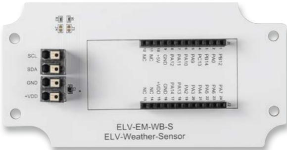
Bild 6: ELV Erweiterungsmodul WB Sensor (ELV-EM-WB-S)
