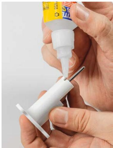
Bild 37: Einkleben der Achse für das Anemometer
