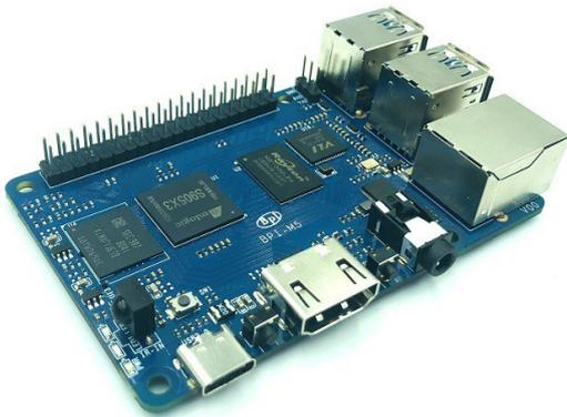
Der Banana Pi M5 ist ein vielseitiger Alleskönner. Er eignet sich sowohl für Linux, als auch für Android Anwendungen. Seine GPIO Schnittstelle ist kompatibel zum Raspberry Pi, dadurch können die meisten Erweiterungsplatinen von Raspberry auch für dieses Board verwendet werden. Die integrierten 16 GB eMMC Flash-Speicher, lassen sich durch eine bis zu 256 GB große micro-SD Karte erweitern.
