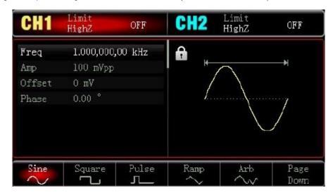
Drücken Sie "Amplitude", um Amplitude einzustellen, geben Sie 1 über den Zahlenblock ein, und wählen Sie die Parametereinheit "Vpp" aus.
