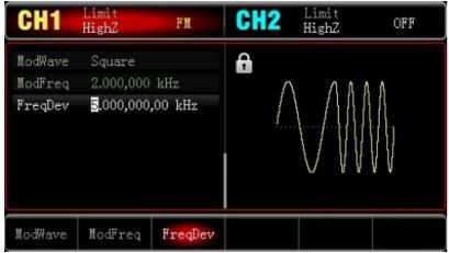
Die FM-Modulationswellenform in Oszilloskop wird wie nachstehend dargestellt:
