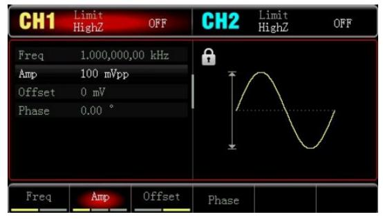
Drücken Sie "Frequenz", um die Frequenz einzustellen, geben Sie 900 über den Zahlenblock ein, und wählen Sie die Parametereinheit "Hz" aus.
