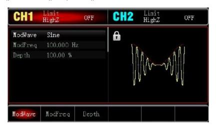
2) Parameter des Modulationssignals einstellen
