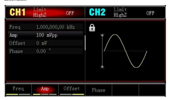
Drücken Sie "Frequenz", um die Frequenz einzustellen, geben Sie 2 über den Zahlenblock ein und wählen Sie die Parametereinheit "kHz" aus.
