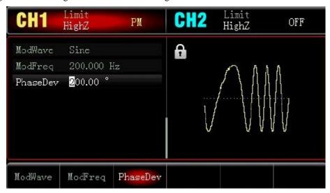
Die PM-Modulationswellenform in Oszilloskop wird wie nachstehend dargestellt:
