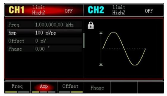
Drücken Sie "Frequenz", um die Frequenz einzustellen, geben Sie 10 über den Zahlenblock ein, und wählen Sie die Parametereinheit "kHz" aus.
