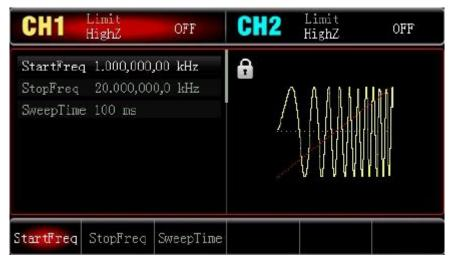
Drücken Sie "Startfrequenz" / "Stoppfrequenz", geben Sie 1 über den Zahlenblock ein, und wählen Sie die Parametereinheit "kHz" aus.
