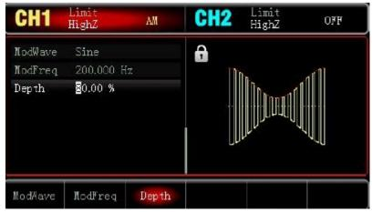
Die AM-Modulationswellenform in Oszilloskop wird wie nachstehend dargestellt:
