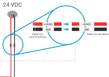
**⚠️ Achtung:** Bitte stellen Sie sicher, dass alle Kabel gut angeschlossen sind, bevor Sie das andere Ende des DC 24V Netzteil-Jack-Verbindungskabels in den Stromanschluss des Monitors einstecken.
