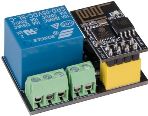
Dieses Relaismodul können Sie mit Hilfe des aufgesteckten ESP-01S Modul frei programmieren und über WLAN fernsteuern. So lassen sich Smarthome-Anwendungen, wie zum Beispiel ein Lichtschalter realisieren.
