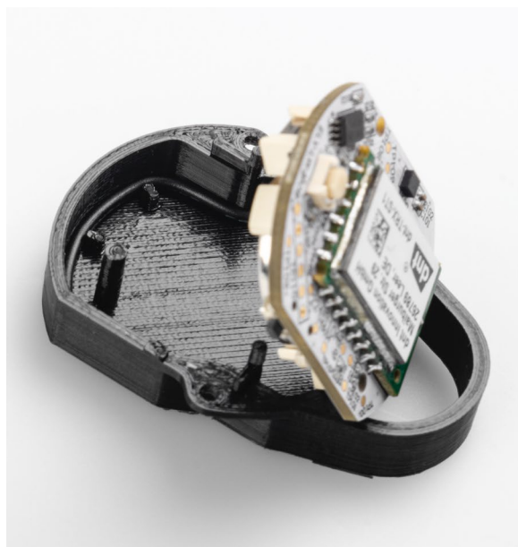
Bild 8: Die Platine wird nach unten in das Gehäuseoberteil geklappt ...
