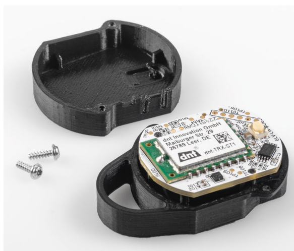
Bild 9: ... und dann flach auf den Stützblöcken des Gehäuseoberteils platziert.
