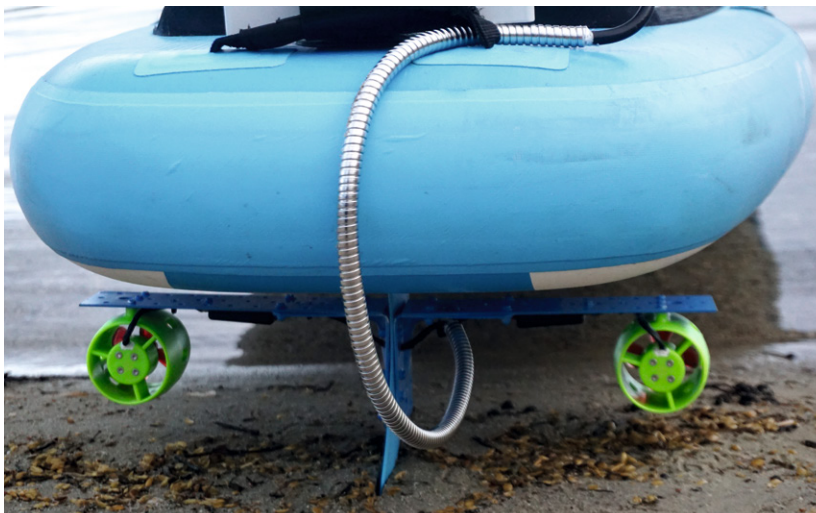
Bild 11: SUP-Montage der Antriebseinheit
