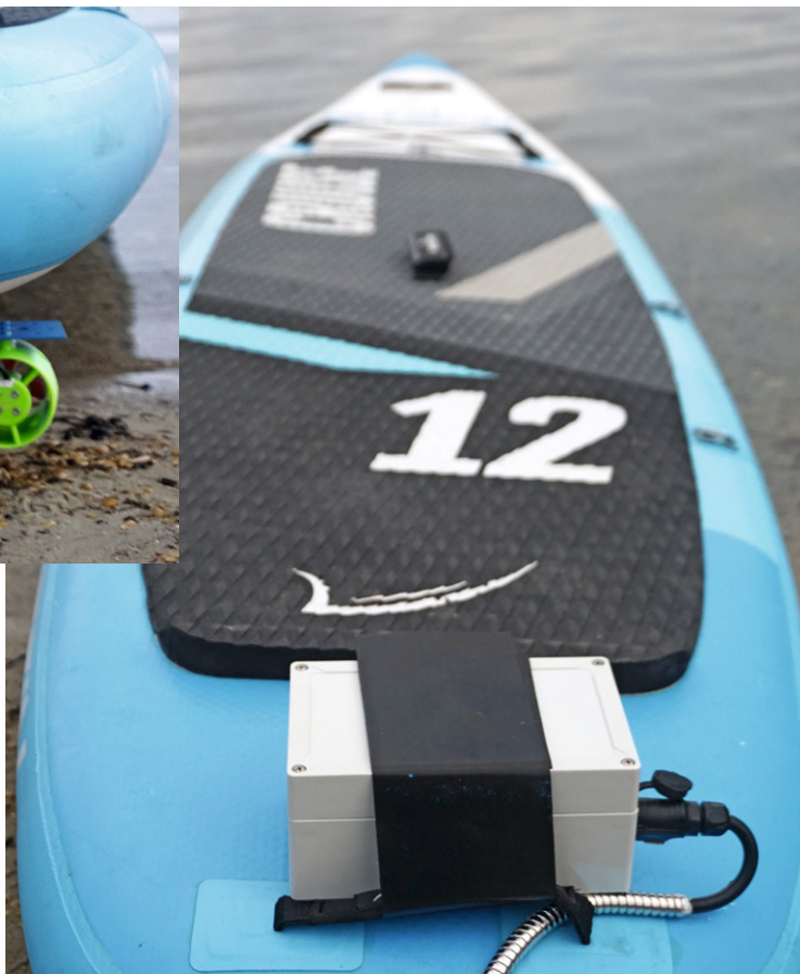
Bild 12: SUP-Montage der Empfangsbox
