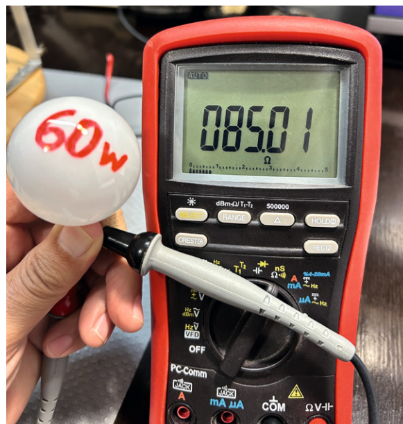
Bild 2: Der Widerstand einer kalten 60-W-Glühlampe
