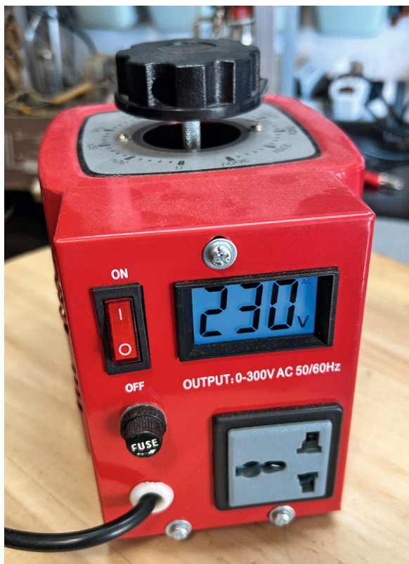
Bild 6: Variabler Spartransformator für die Elektronikwerkstatt
