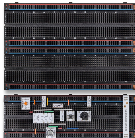
Bild 3: oben: Kombinierte Steckboards; unten: Schaltung auf einem Steckboard
