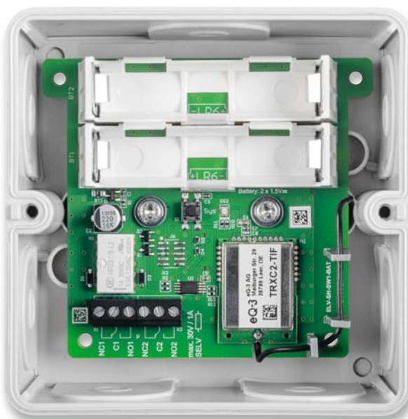
Bild 13: Montage der Platine in einer Spelsberg Verbindungsdose Abox 040
