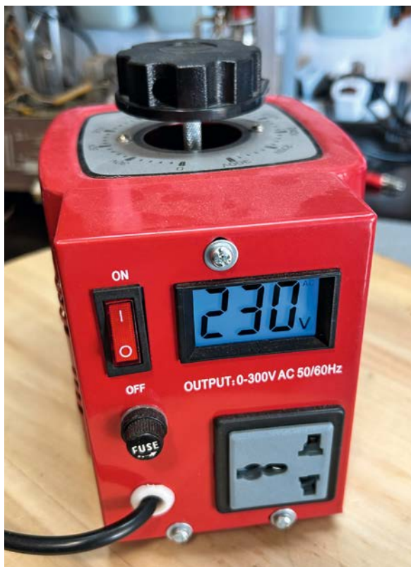
Bild 6: Variabler Spartransformator für die Elektronikwerkstatt
