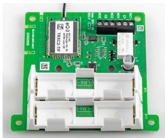
Bild 9: Montage der Schraubklemmen
