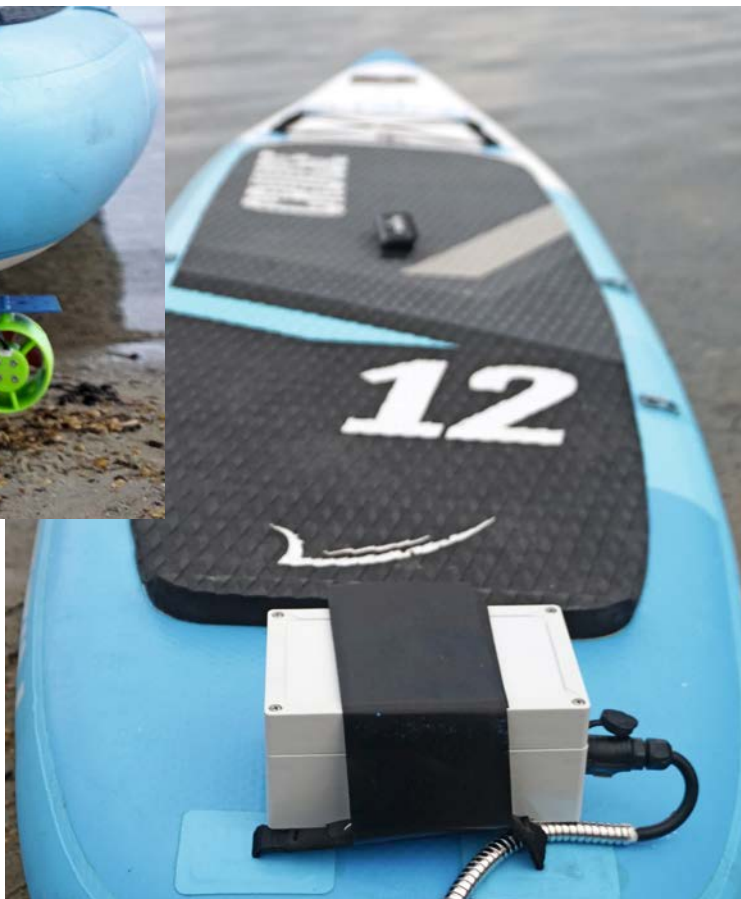
Bild 12: SUP-Montage der Empfangsbox
