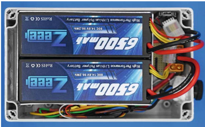
Bild 9: Fertig aufgebaute Empfangsbox
