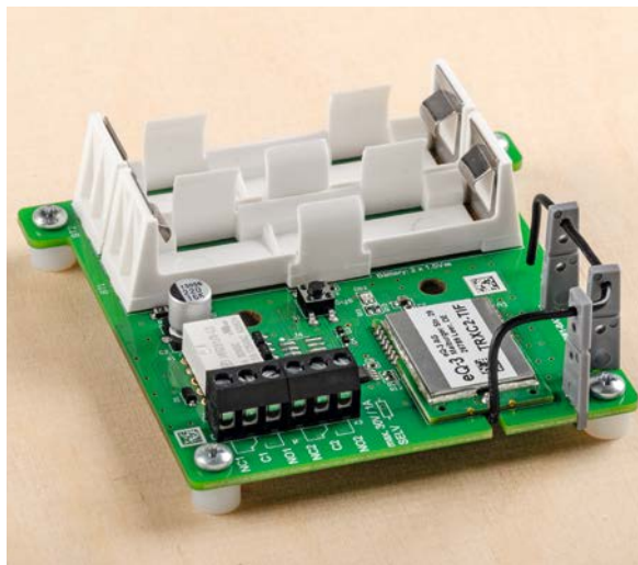
Bild 12: Befestigung der Platine mit Abstandshaltern und Schrauben
