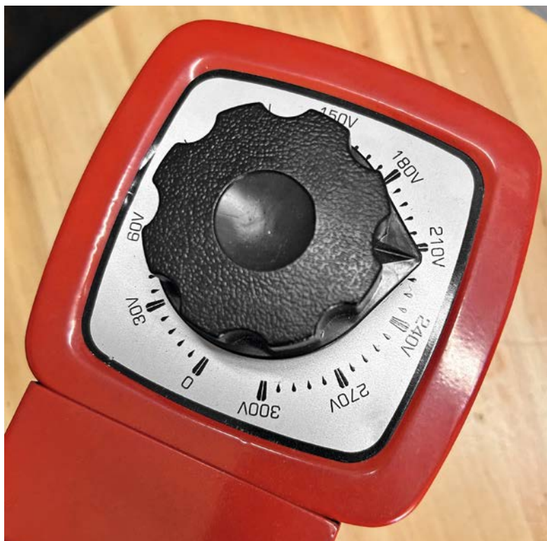
Bild 7: Die Ausgangsspannung kann sogar die Eingangsspannung übersteigen, in diesem Fall auf bis zu 300 VAC.
