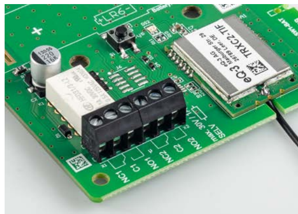
Bild 9: Montage der Schraubklemmen
