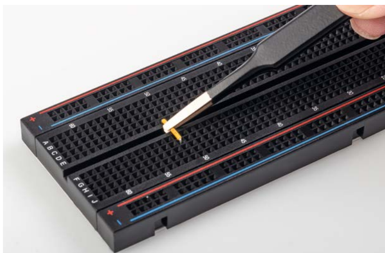
Bild 28: Mit einer Pinzette können die Steckbrücken einfach eingesetzt und entfernt werden.
