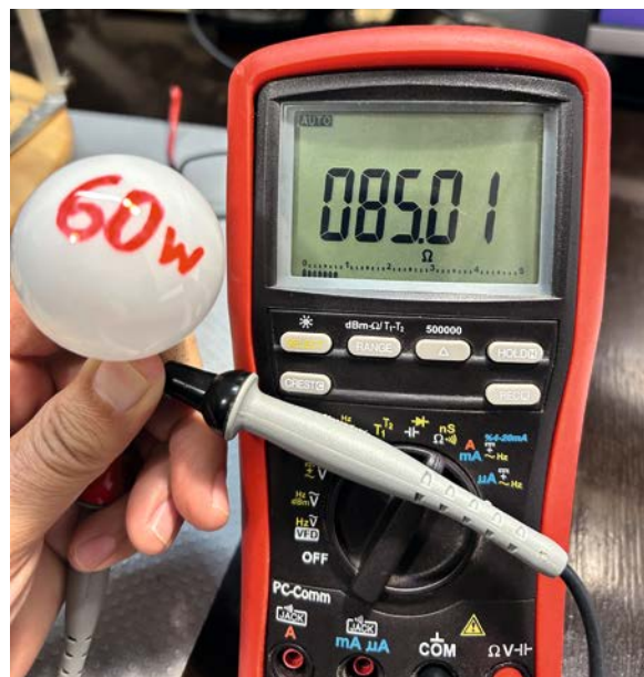
Bild 2: Der Widerstand einer kalten 60-W-Glühlampe
