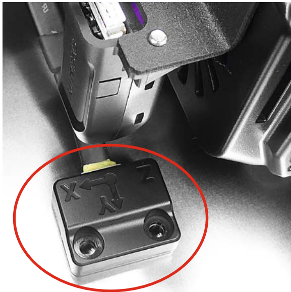
Bild 14: Über den mitgelieferten Sensor werden die Konfigurationsdaten für die „Input Shaping“-Funktion ermittelt.
