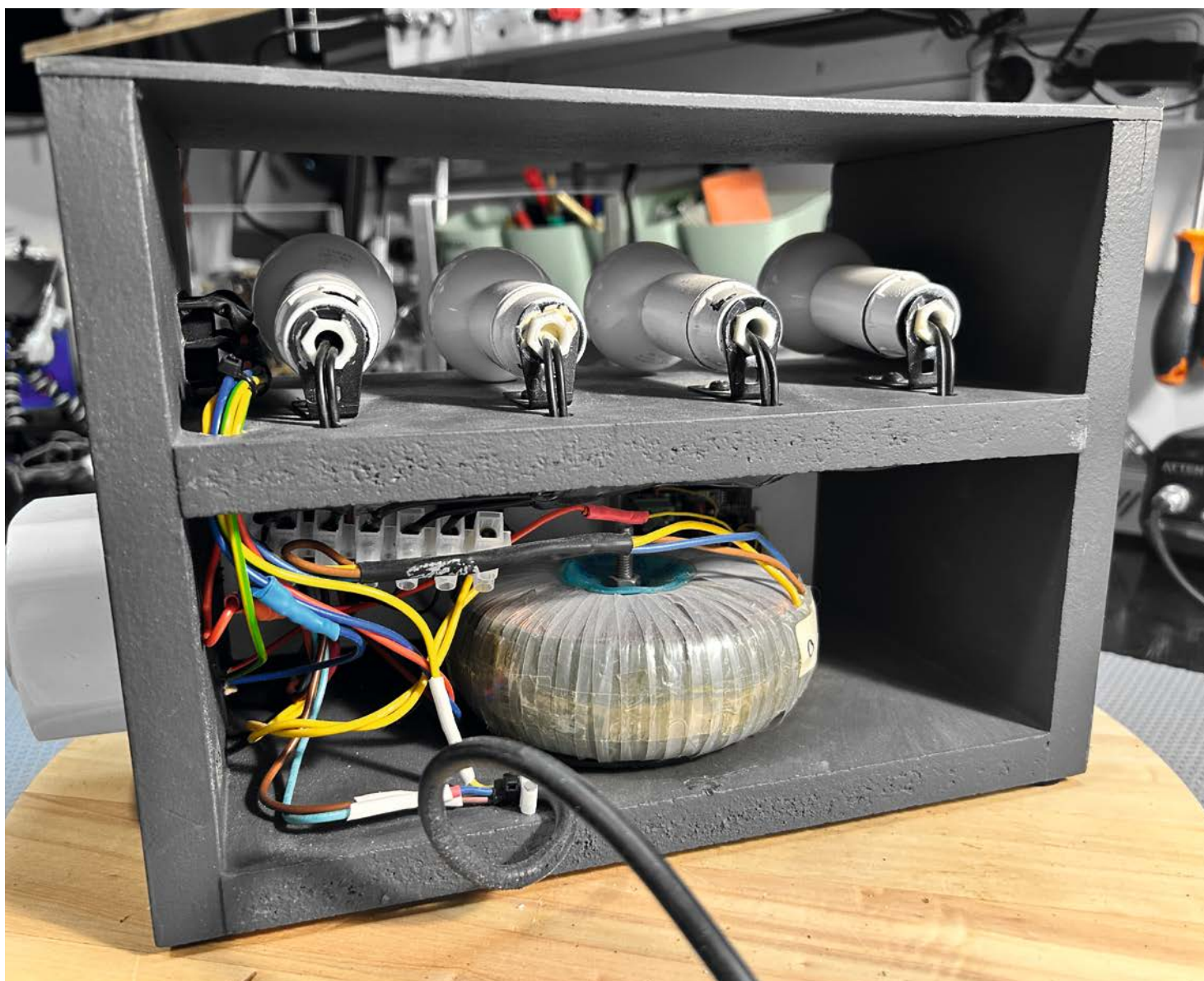
Bild 10: Die interne Verdrahtung des Lampenstrombegrenzers bzw. Trenntransformators
