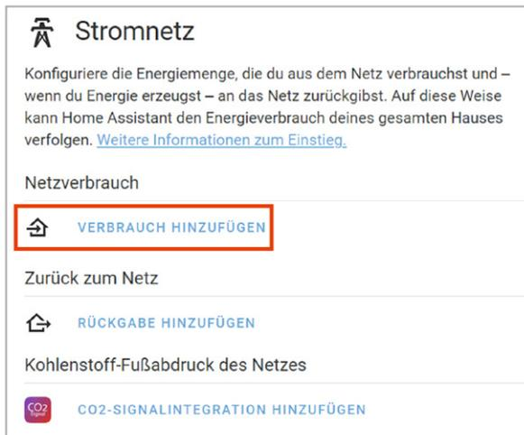
Bild 36: Hinzufügen des Stromzählers
