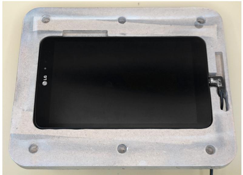
Bild 2: Gefrästes Gehäuseunterteil
