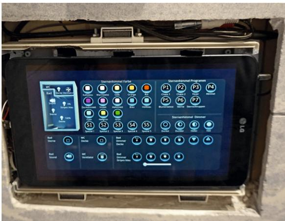
Bild 5: Unterputzeinbau des Tablets im Bad
